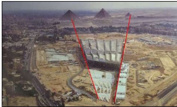
Figura 90: Volumetría del museo (fotografía), se muestra que los ejes que limitan el GME, están dirigidos hacia las pirámides.
