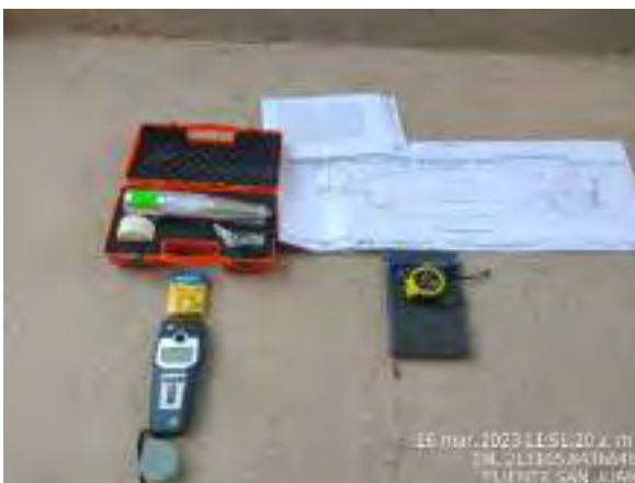
Equipos Básicos para la Estimación de la Resistencia del Concreto del Puente San Juan
