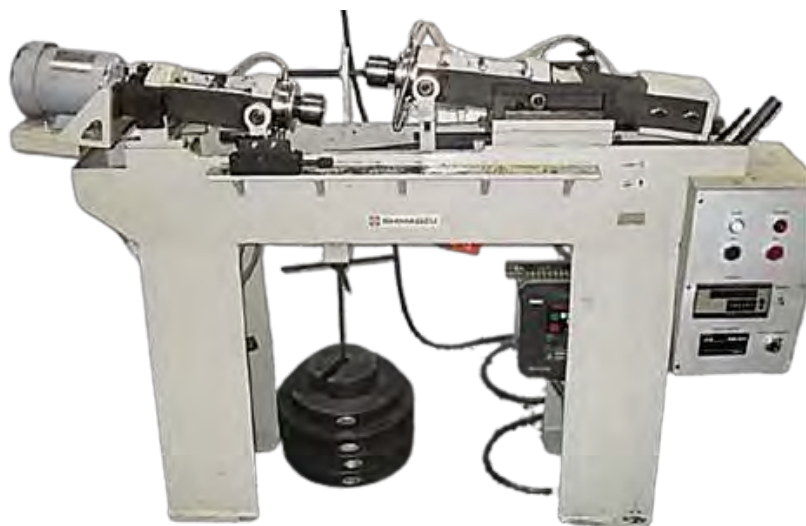
Figura 8. Banco de Moore construida por Shimadzu, para variar la carga aplicada a la probeta, se muestra las pesas, (Di Brico y Mollerach, 2015).
