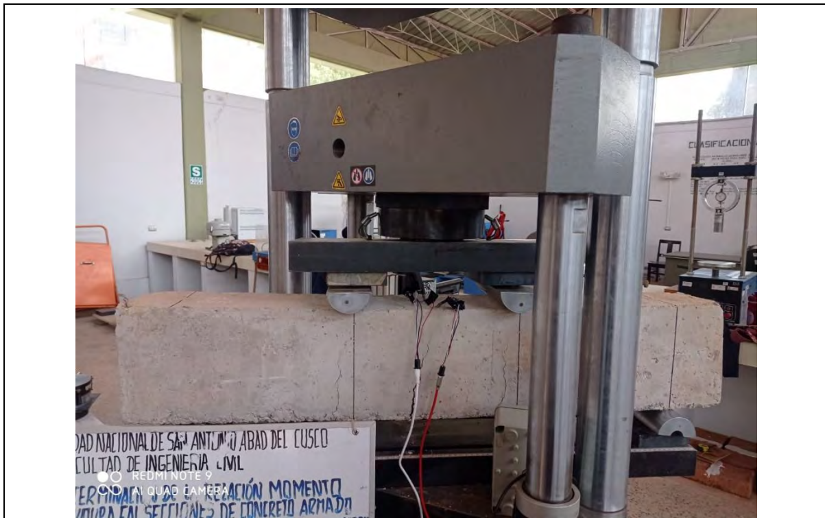
Ensayo a flexión en vigas doblemente armadas con 0% F.A.en la Máquina Universal
