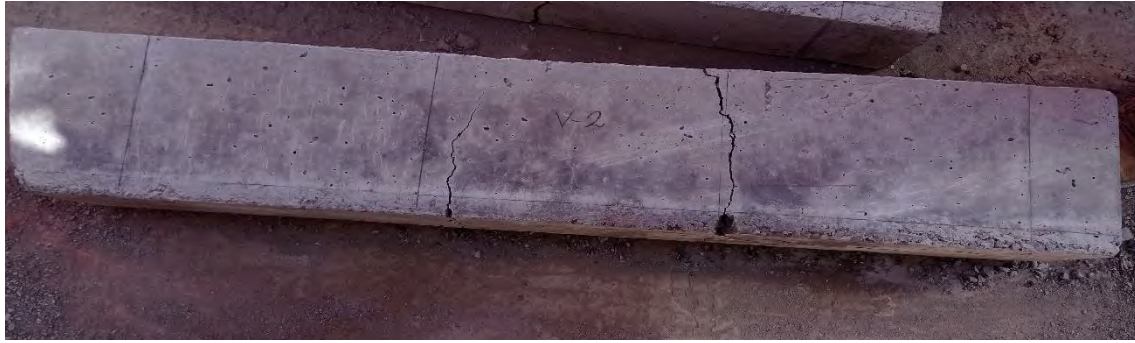
Viga N° 02 con 0% de fibra de acero – falla con la carga máxima aplicada
