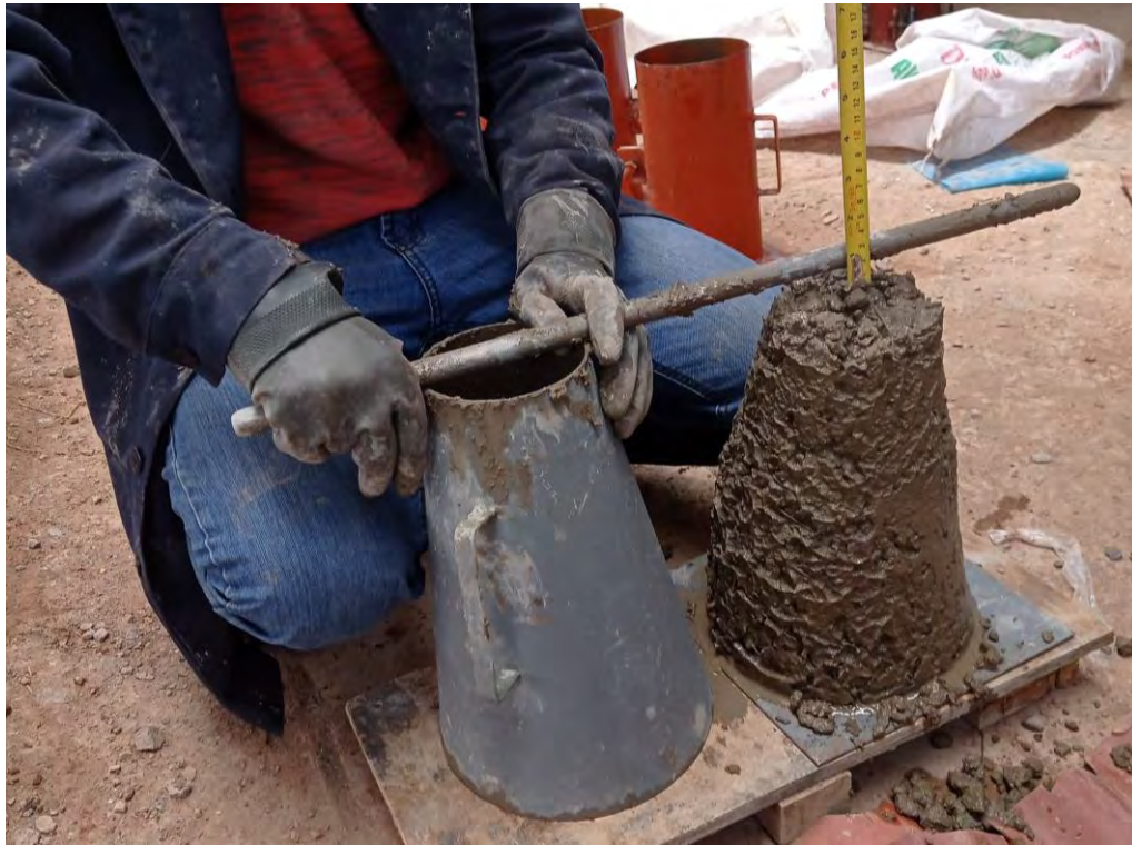
Prueba de revenimiento para verificar el SLUMP del concreto
