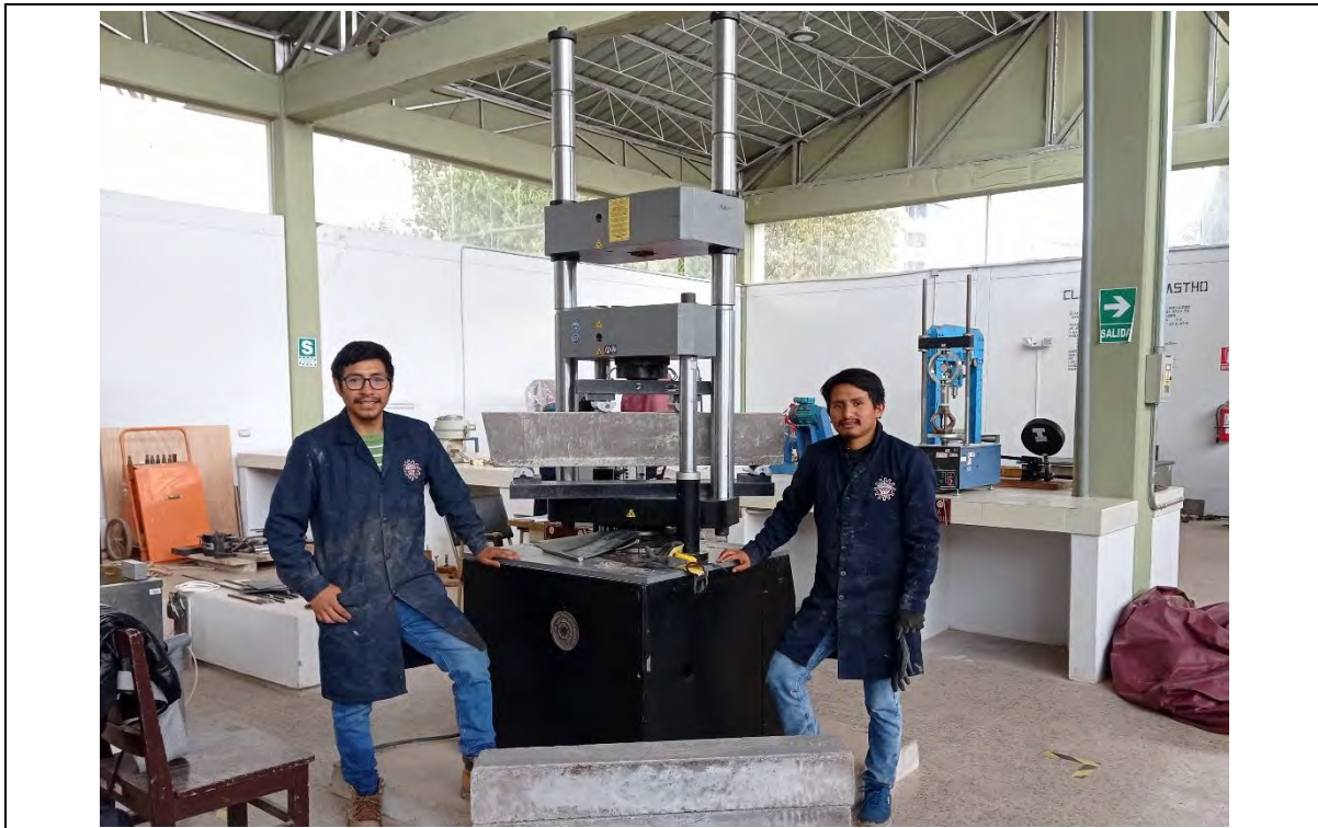
Ensayo a flexión en vigas simplemente armadas con 1% en la Máquina Universal
