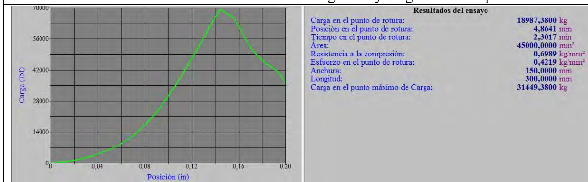
Probeta N° 09 con 1% de fibra de acero – gráfica y carga máxima aplicada
