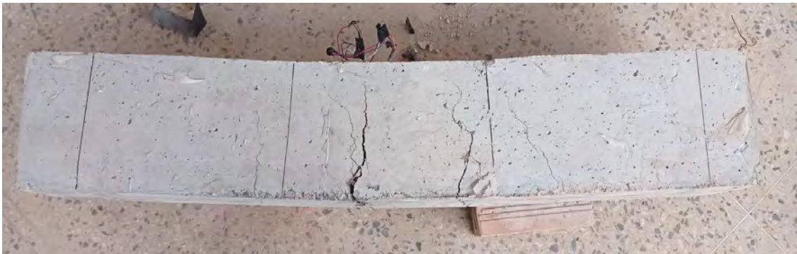
Viga N° 03 con 0% de fibra de acero – falla con la carga máxima aplicada
