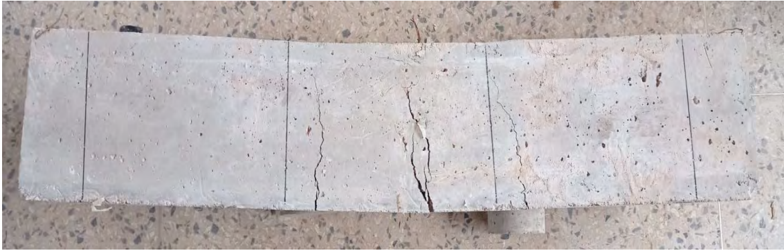
Viga N° 02 con 1% de fibra de acero – falla con la carga máxima aplicada
