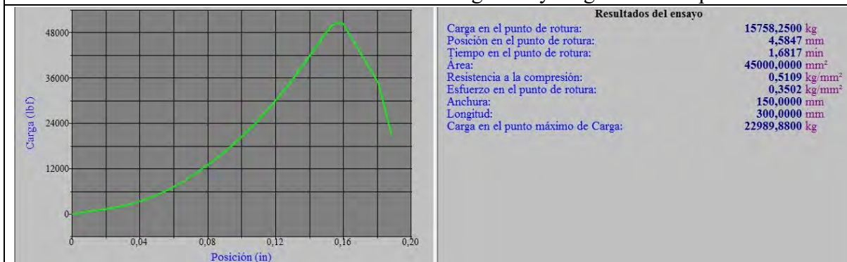
Probeta N° 02 con 0% de fibra de acero – gráfica y carga máxima aplicada
