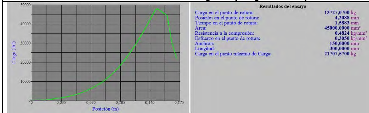
Probeta N° 08 con 0% de fibra de acero – gráfica y carga máxima aplicada
