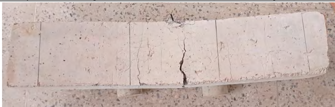
Viga N° 01 con 1% de fibra de acero – falla con la carga máxima aplicada
