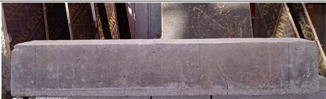
Ensayo a flexión en vigas simplemente armadas con 0% de fibra de acero en la Máquina Universal
