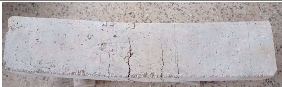
Viga N° 01 con 0% de fibra de acero – falla con la carga máxima aplicada
