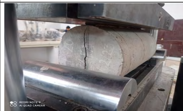
Falla con carga máxima aplicada
