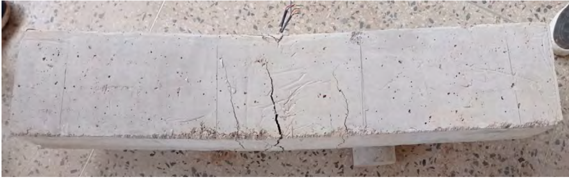
Viga N° 02 con 0% de fibra de acero – falla con la carga máxima aplicada
