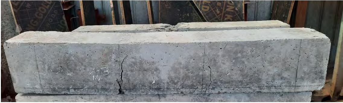
Viga N° 02 con 1% de fibra de acero – falla con la carga máxima aplicada
