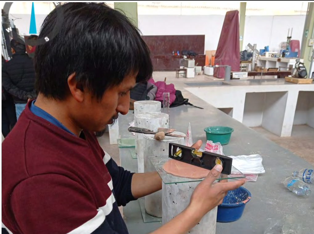
Capping con yeso dental para el ensayo a compresión del concreto
