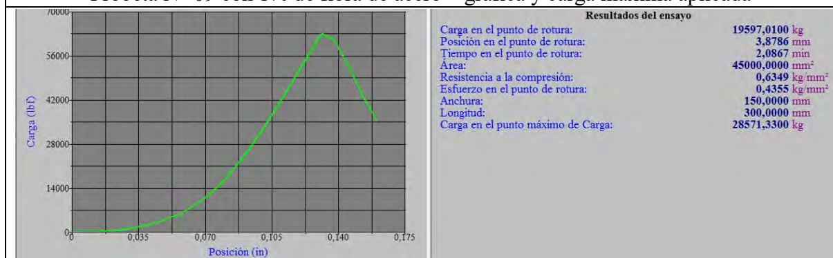
Probeta N° 10 con 1% de fibra de acero – gráfica y carga máxima aplicada
