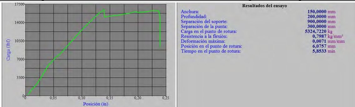
Viga N° 02 con 0% de fibra de acero – falla con la carga máxima aplicada
