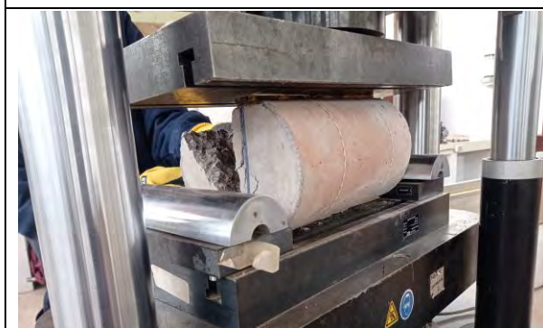
Falla frágil con carga máxima aplicada
