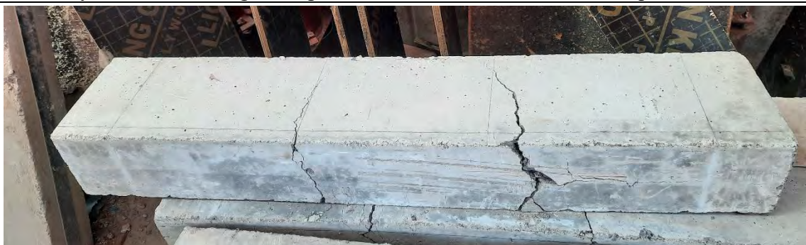
Ensayo a flexión en vigas simplemente armadas con 1% en la Máquina Universal
