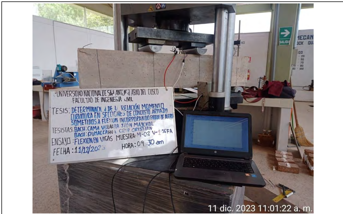
Ensayo a flexión en vigas doblemente armadas con 1% F.A. en la Máquina Universal
