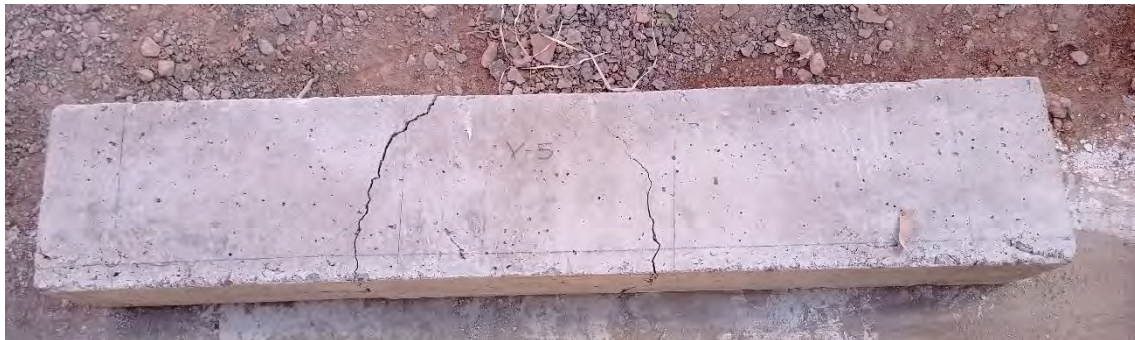
Viga N° 02 con 0% de fibra de acero – gráfica y carga máxima aplicada
