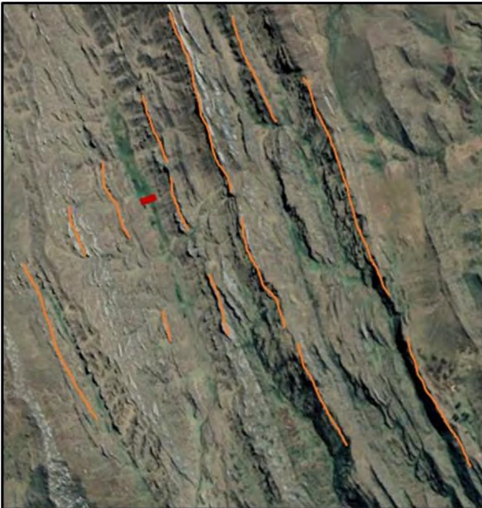
*Imagen 03. Orientación de la estratificación, no existen fallas locales que puedan afectar la estructura del Vaso (FUENTE: Propia.)*
