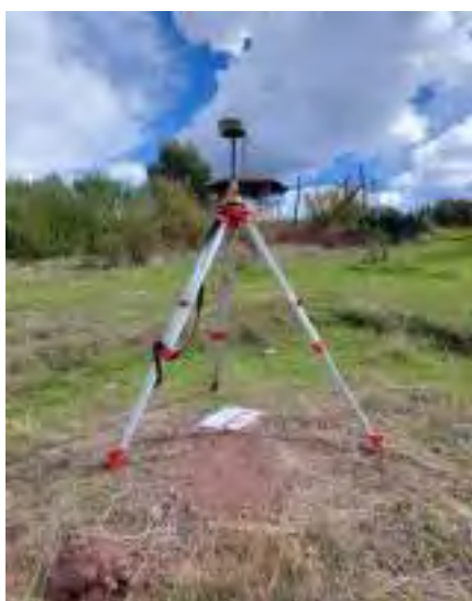
Figura N° 3 Gnns diferencial FOIF A90 (estación base)
