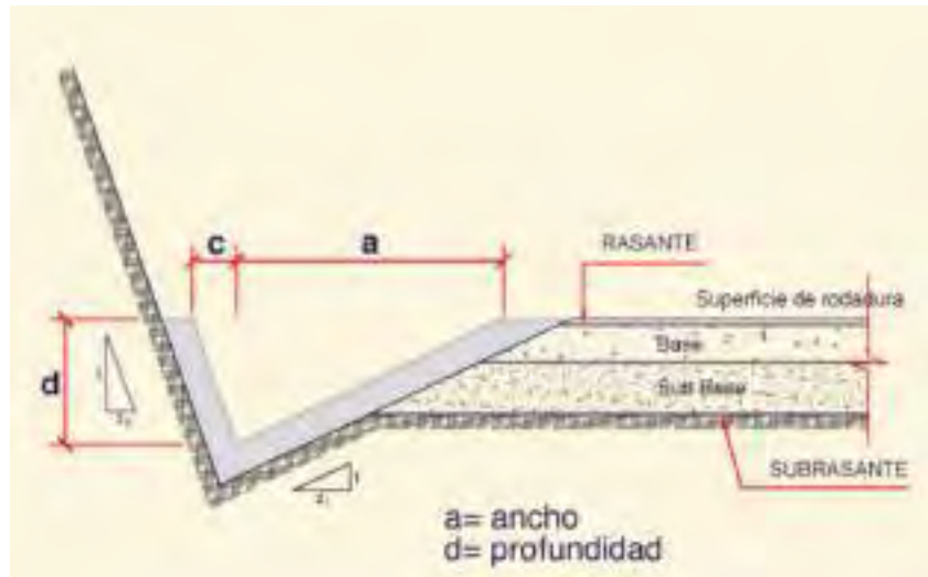
Figura N° 74 Dimensiones de cuneta triangular planteada
