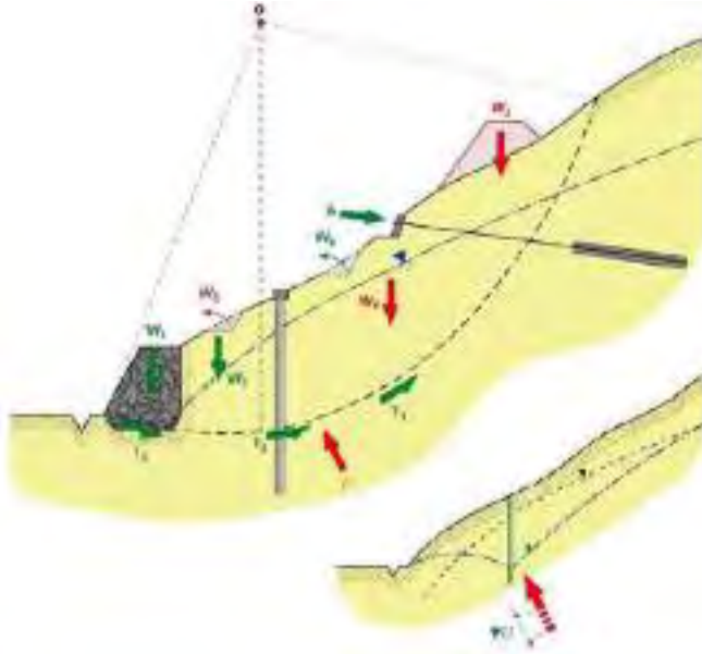
Figura 6.17. Diagrama de fuerzas y Momentos de estabilidad de taludes
