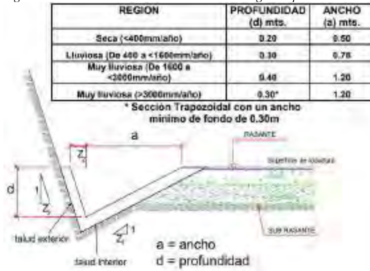
Figura 6.29. Dimensiones mínimas de cuneta triangular típica
