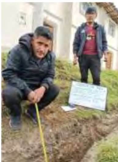
Calicata N°01 km: 00+780 – C.P Trancapata baja. Material orgánico marrón, humedad baja y textura franco limoso arcilloso.
