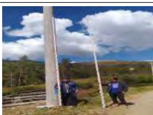
Ubicación de la Mira Topográfico en el BM-06, en el tramo I.
