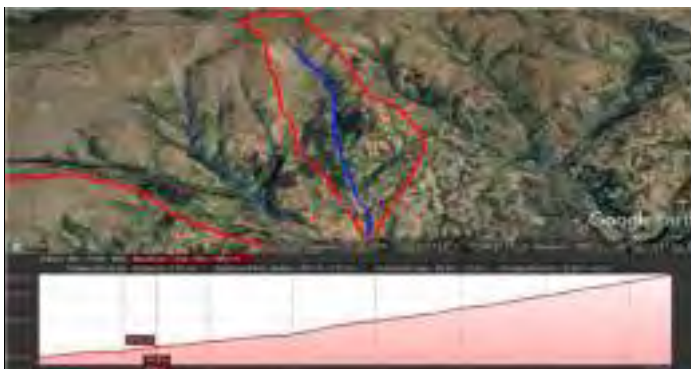
Figura 5.7. Cuencas para las alcantarillas más críticas
