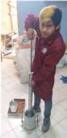
Figura 4.13. Proceso de compactación con pisonos
