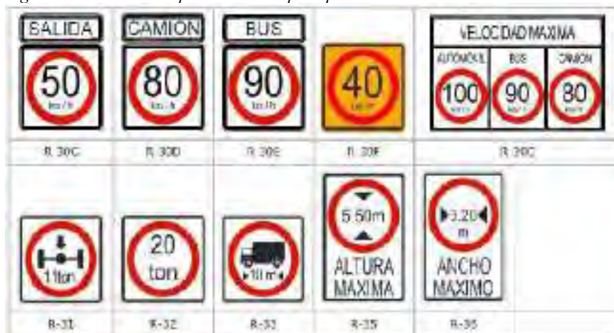
Figura 6.38. Señales de prohibición de paso por clase de vehículo
