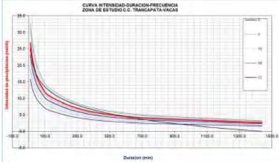
Figura 5.6. Curva Intensidad–Duración–frecuencia para la Zona de estudio C.C. Trancapata- Sulbario
