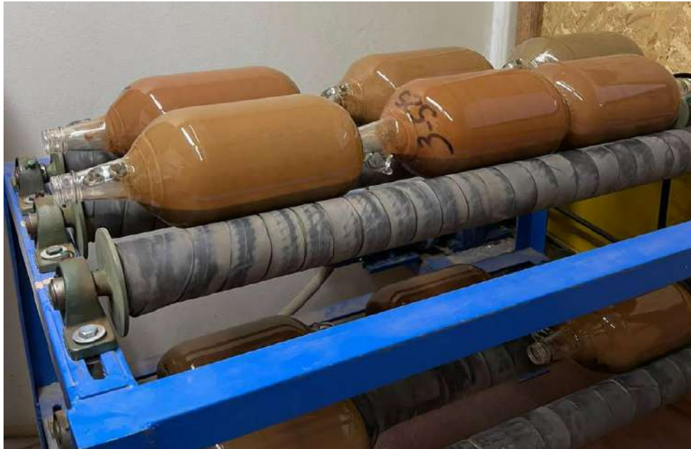
Foto 6: Mesa de rodillos para correr pruebas metalúrgicas
