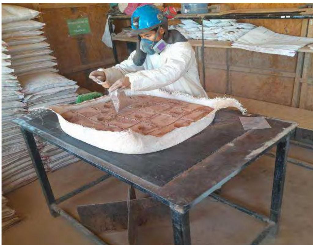
Foto 4: Cuarteo de mineral pulverizado por el método Damero
