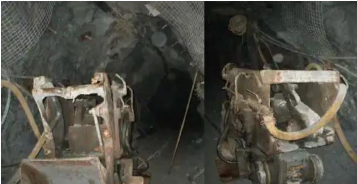
*Nota.* Pala neumática en la galería 590. Zona Rampa.
