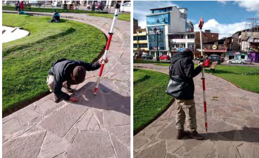
Colocación de Puntos de Apoyo y Puntos de Verificación
