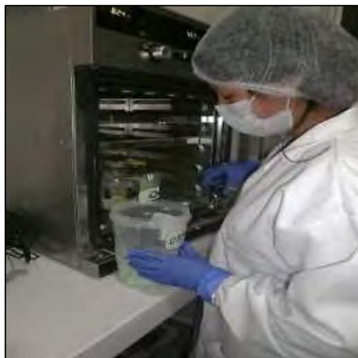
**7. Confección de bloques:** Una vez que fueron retirados del parafinado, se derritió la parafina en un dispensador para la obtención de un bloque sólido con la muestra del tejido, se utilizó un molde previamente relleno con parafina líquida donde se colocó el tejido, luego se colocó en una superficie fría, donde se solidificó el molde para su respectivo corte histológico, como se puede apreciar en la figura 7.
