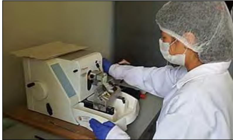
**9. Confección de las láminas histológicas:** Para confeccionar las láminas correspondientes, la tira fue recogida del microtomo y se colocó en la superficie del baño de flotación a una temperatura constante de 48 °C para que se suelte y se estire, posteriormente se recogió los cortes con una lámina de portaobjetos previamente codificados y se dejó secando por 18 horas, como se puede apreciar en la figura 9.
