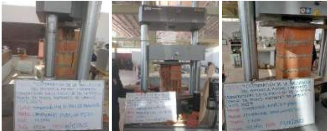
Compresión axial de pilas de albañilería
