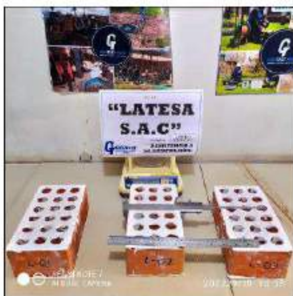
LADRILLO Nº 01, 02 y 03 Vista de la muestra antes del Ensayo de Resistencia a la Compresión.
