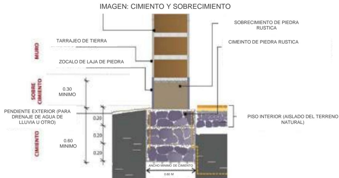
Fuente: Norma E.080 Diseño Y Construcción Con Tierra Reforzada. Recuperado de: [https://cdn-web.construccion.org/normas/me2012/me2006/files/titulo3/02\\_E/E\\_080.pdf](https://cdn-web.construccion.org/normas/me2012/me2006/files/titulo3/02_E/E_080.pdf)
