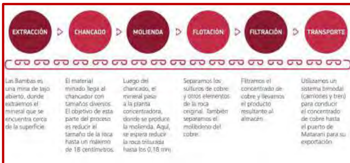
Ilustración 86. Flujo del Proceso Productivo en Minera las Bambas.
