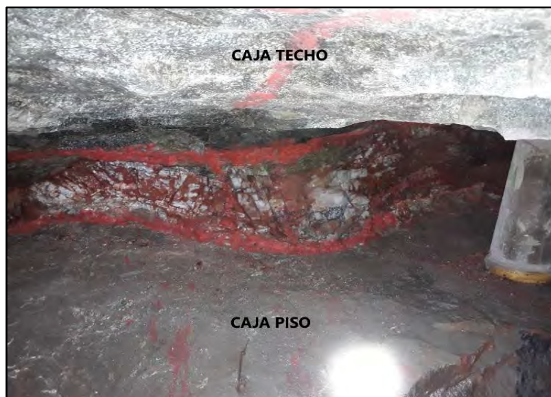
Fotografía 5: Clavo mineralizado de Cuarzo hialino con Oxidos de Hierro (Hm, goe) con halos de Alteración propilítica. Fuente: Elaboración propia.
