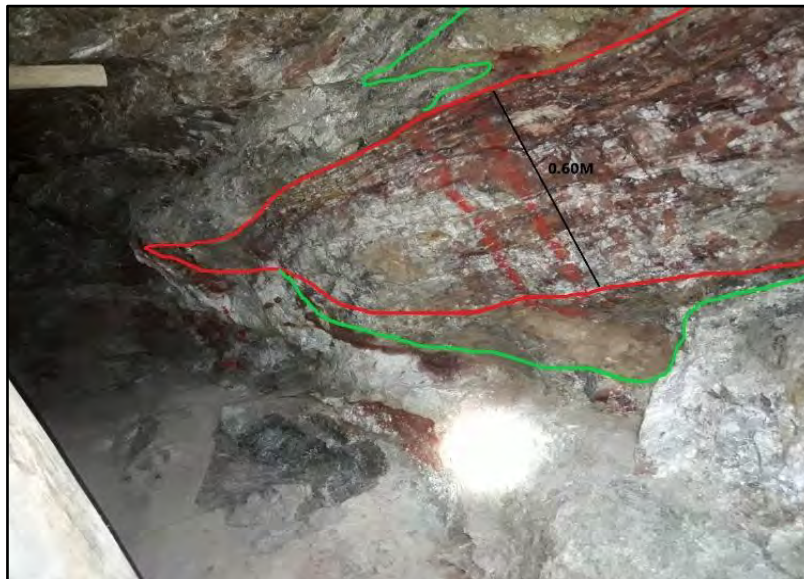
Fotografía 4: Clavo mineralizado de Cuarzo hialino con Oxidos de Hierro (Hm, goe) con halos de Alteración propilitica. Fuente: Elaboración propia
