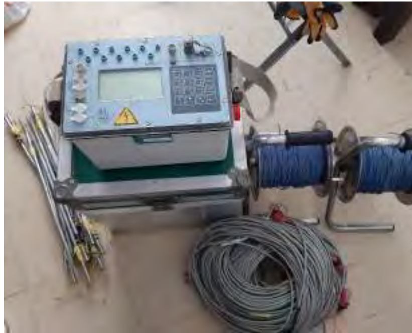
Figura 92: Resistivimetro Syscal Pro 10 canales
