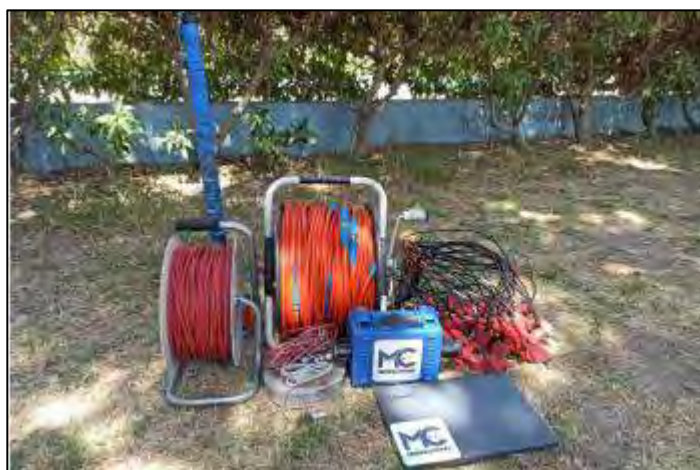
Figura 86: Sismógrafo Dolang utilizado en el estudio
