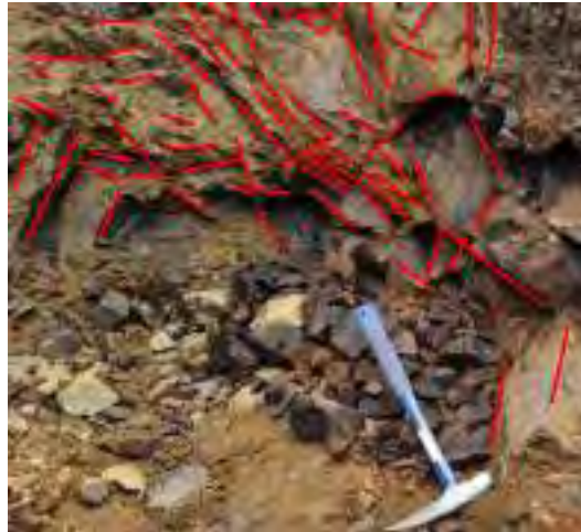
Figura 59: Sistemas de diaclasas en la estación 5.
