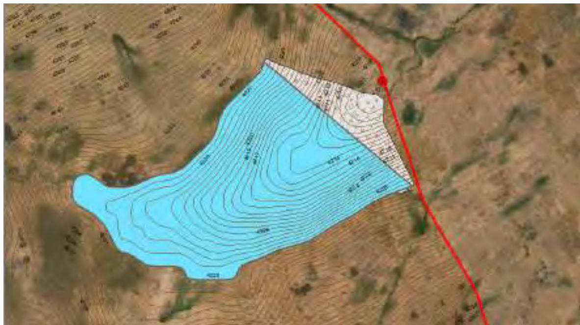
Figura 72: Levantamiento topográfico de área posible de inundación
