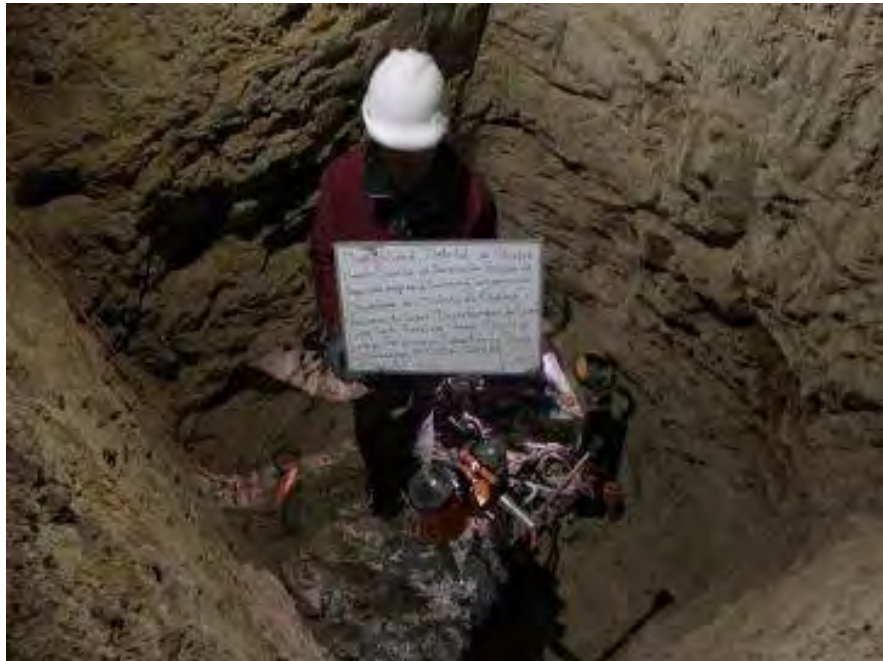
Figura 98: Calicata C-5 perteneciente al estribo dercho del eje de la Presa
