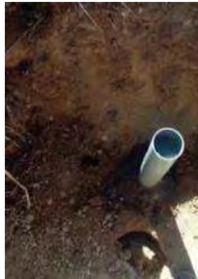
Figura 74: Prueba de permeabilidad en Suelo Fluvioglacial
