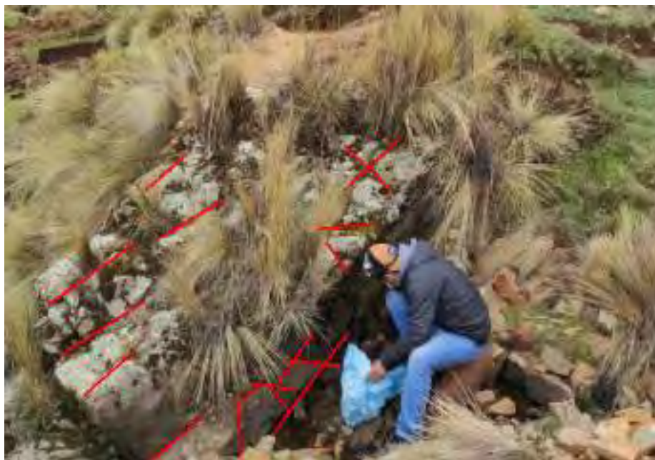
Figura 56: Sistemas de diaclasas en la estación 4.
