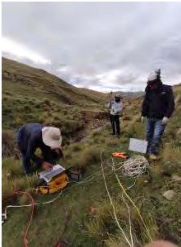
Figura 87: Registro de la data sísmica-01 en el vaso de la presa de Chocayhua.
