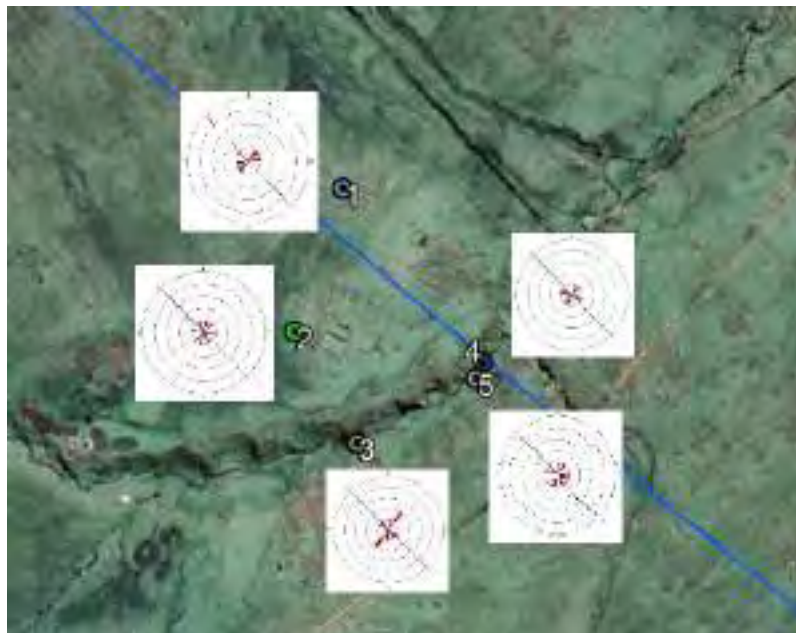
Figura 60: Vista en planta del área de emplazamiento del dique de la presa, mostrando las zonas de trabajo y sus respectivos diagramas de rosa, con dos familias, el principal con dirección NE-SW y el segundo con dirección NW-SE.
