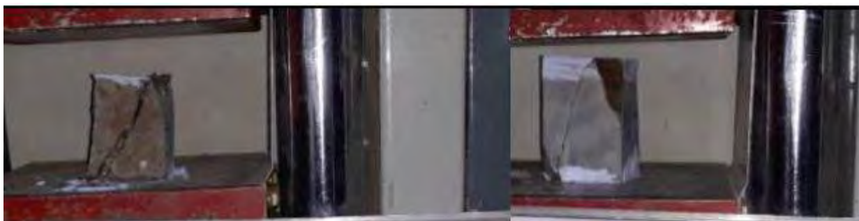
Figura 107: Resistencia a compresión de los núcleos de la EG04.
