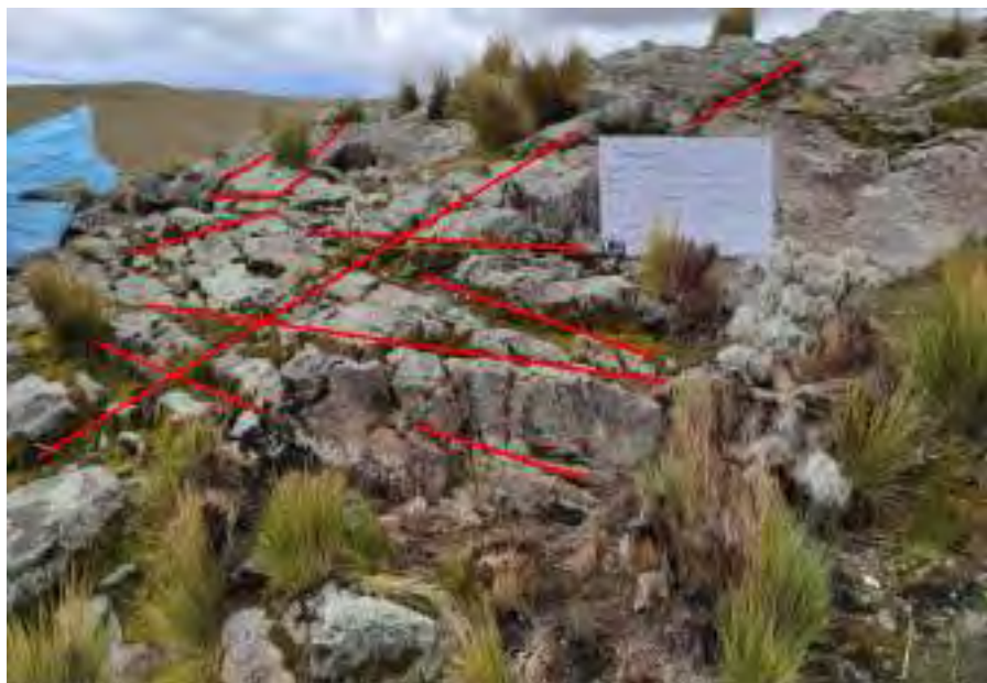
Figura 46:Sistemas de diaclasas en la estación 1.
