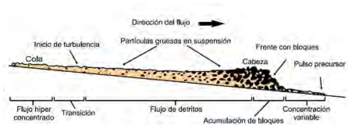
Figura 2 : Esquema de flujos canalizados y no canalizados, según Cruden y Varnes (1996).
