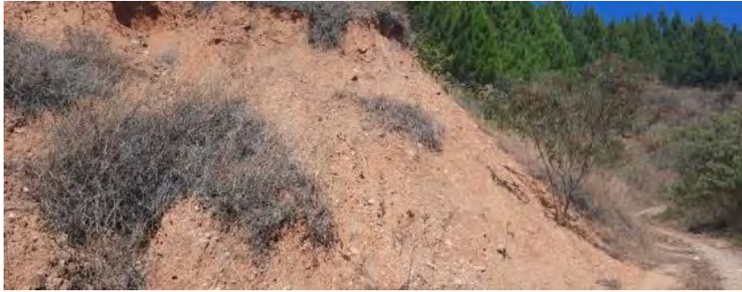
Foto 5: Vista frontal de los depósitos coluviales, gravas de tamaño mediano, con bastante presencia de finos (Arcillas y limolitas) (E 777375 - N 8601815).
