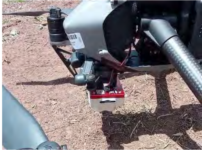
Cámara multispectral MicaSense RedEdge MX
