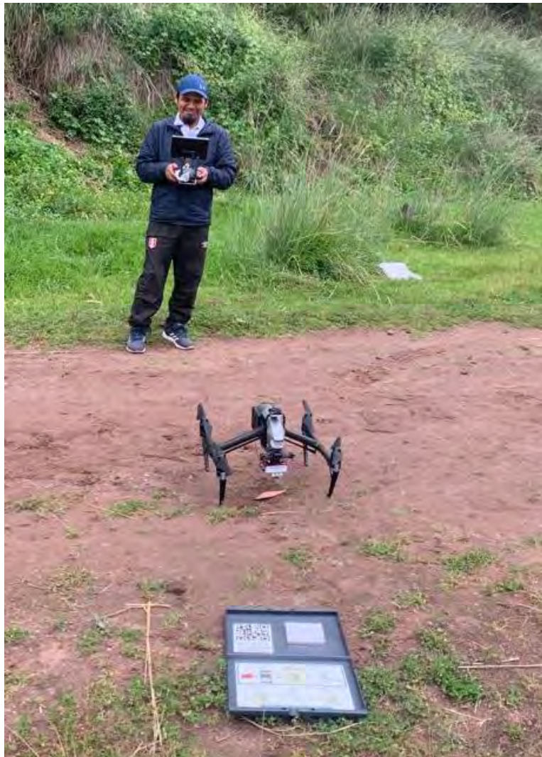
Previo al vuelo, foto en panel de calibración
