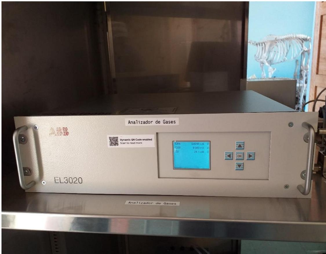
**Fotografía 1. Equipo analizador de gases (ABB Automation Products GmbH Alzenau, Easyflow 3020, Alemania).**
