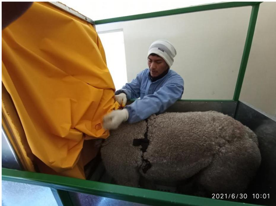
**Fotografía 13. Sujeción de la tela retráctil de la cámara dinámica en la base del cuello de la alpaca.**
