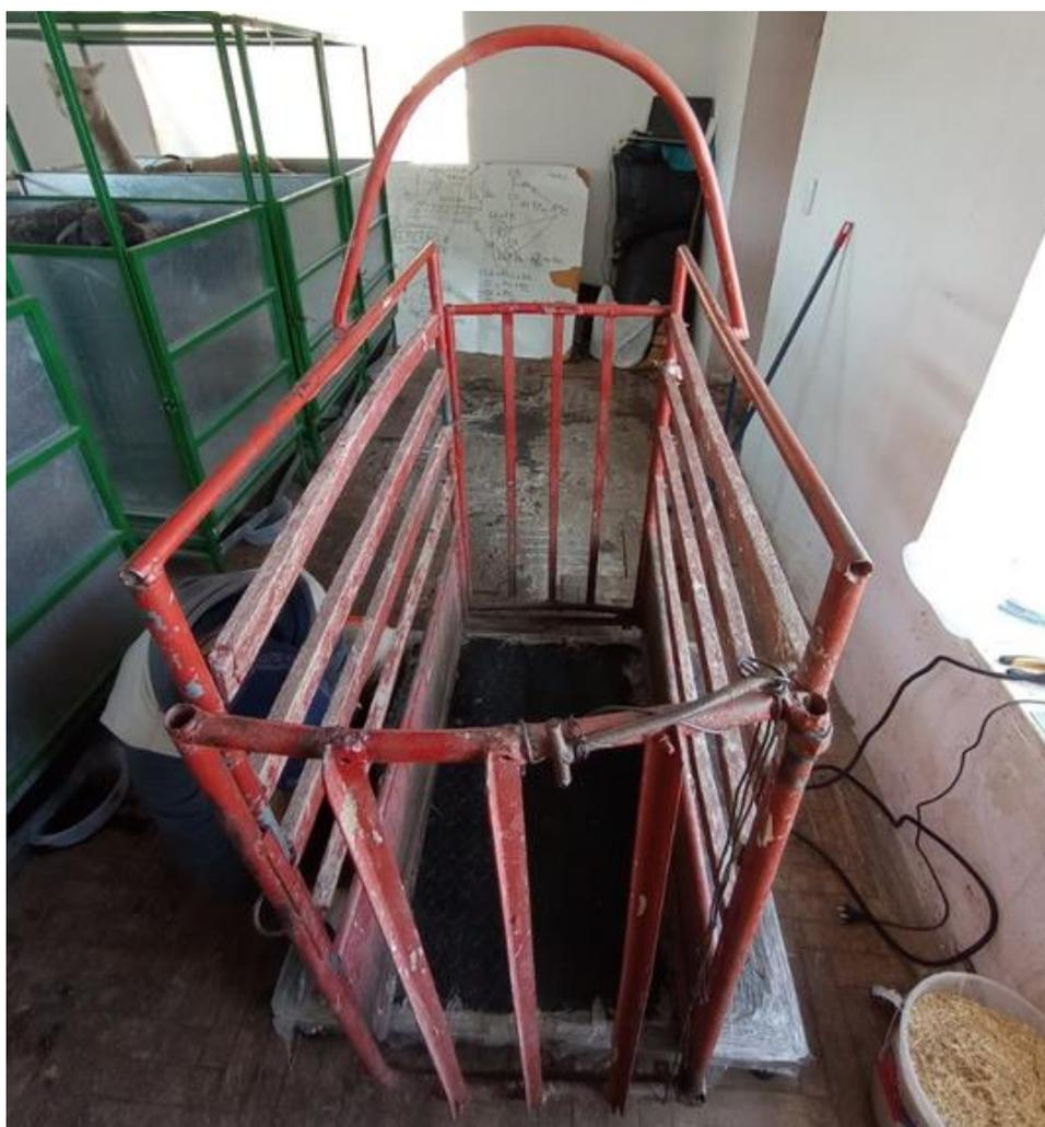
**Fotografía 7. Balanza de tipo plataforma provista de jaula.**
