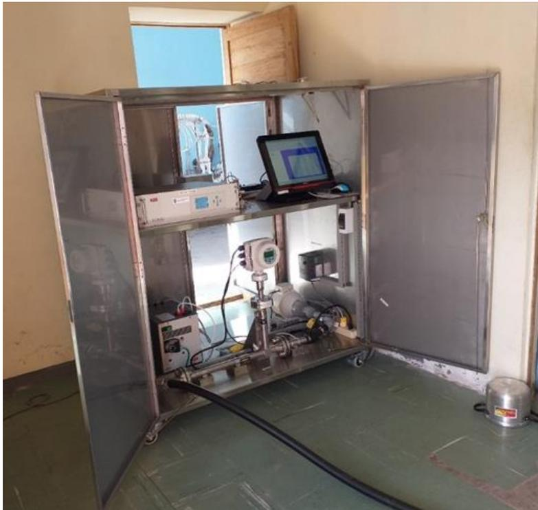
**Fotografía 11. Equipo móvil de calorimetría indirecta de circuito abierto para pequeños rumiantes.**
