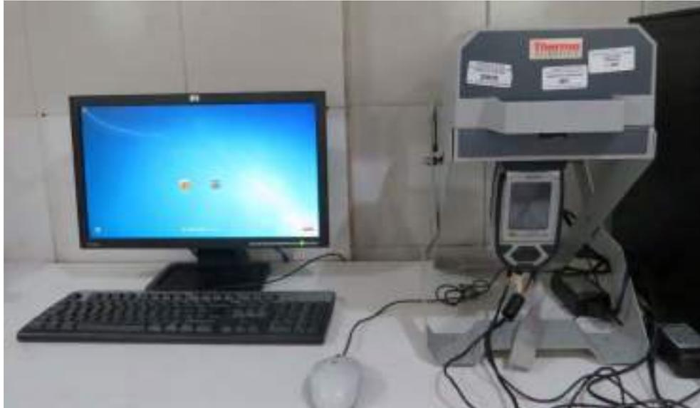
*Fig. 54* En la imagen se puede apreciar el aparato de Fluorescencia de Rayos X, conectado a un ordenador para así procesar los resultados, fuente: TESISTA.
