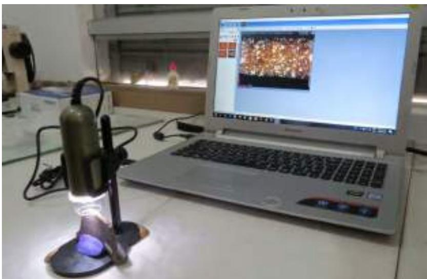
*Fig. 53* Imagen dónde se puede apreciar la toma de imágenes a través del microscopio portátil Dino Lite, modelo AM4113ZT(R4), fuente: TESISISTA.
