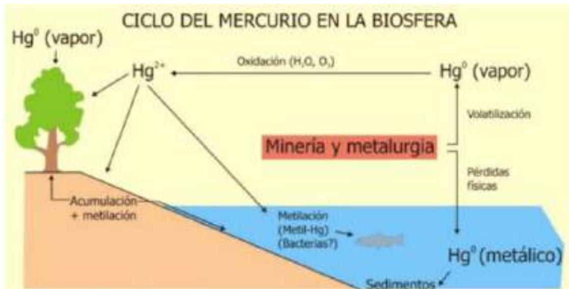
Ilustración 2. Ciclo del Hg en la biosfera y fenómenos de especiación
