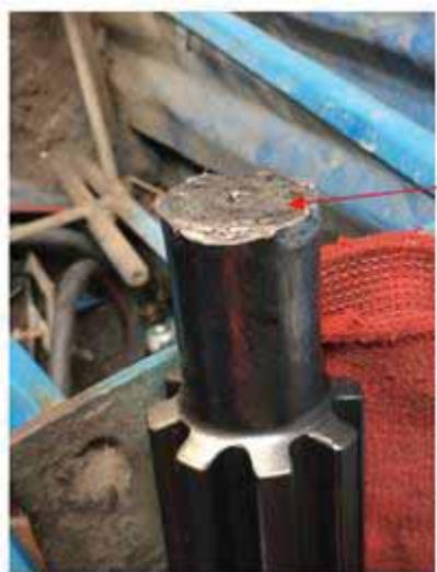
Daños en los elementos de la columna de perforación por perforar con presiones de percusión inadecuadas.
