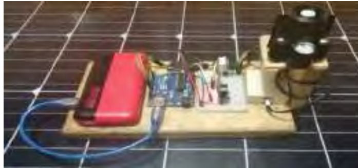
Figura 33: Implementación del sistema que mide variables ambiental (Elaboración propia).
