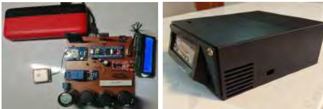
Figura 62: Circuito implementado y escaneo de la cubierta externa (Elaboración propia).
