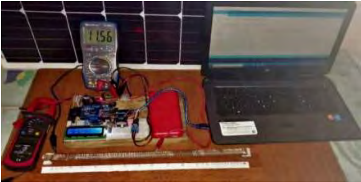
Figura 43: Implementación del sistema de medición de potencia (Elaboración propia).
