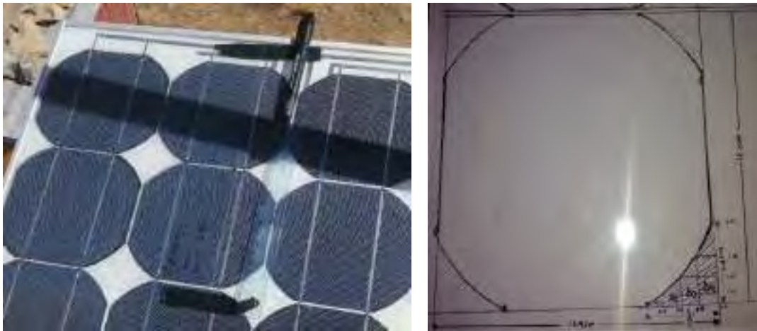
Figura 71: Método utilizado para calcular el área del panel fotovoltaico (Elaboración propia).
