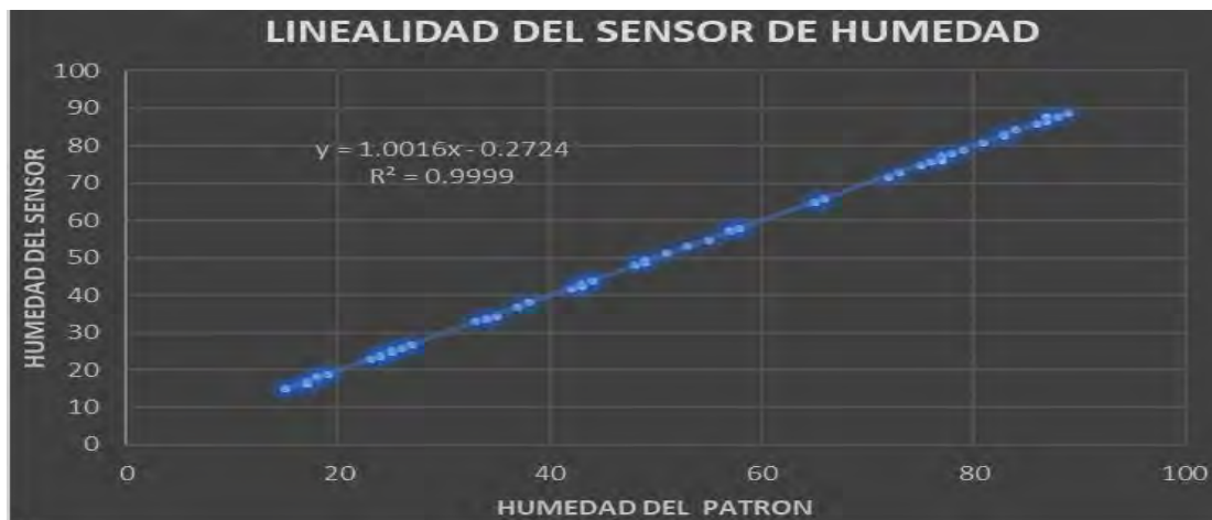
Figura 38: Húmeda SENAMHI vs humedad sistema implementado (Elaboración propia).
