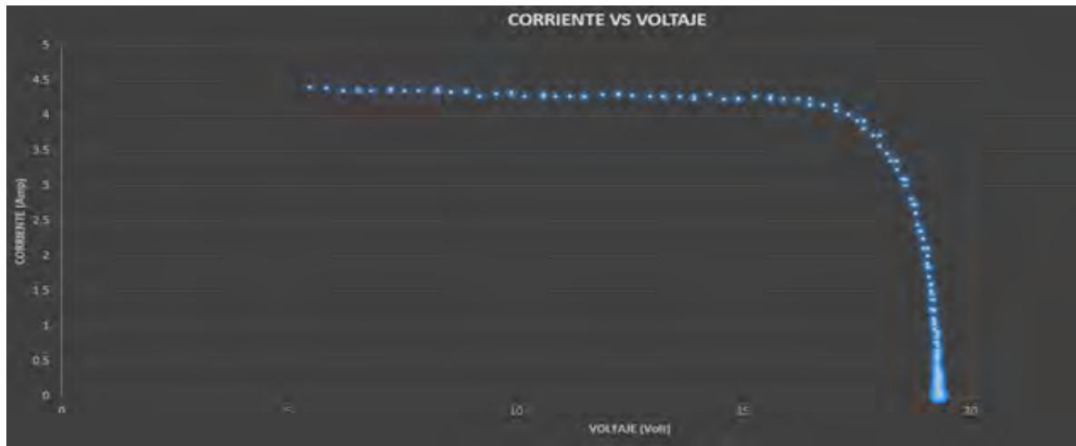
Figura 59: Corriente vs voltaje del proceso de carga del capacitor (Elaboración propia).
