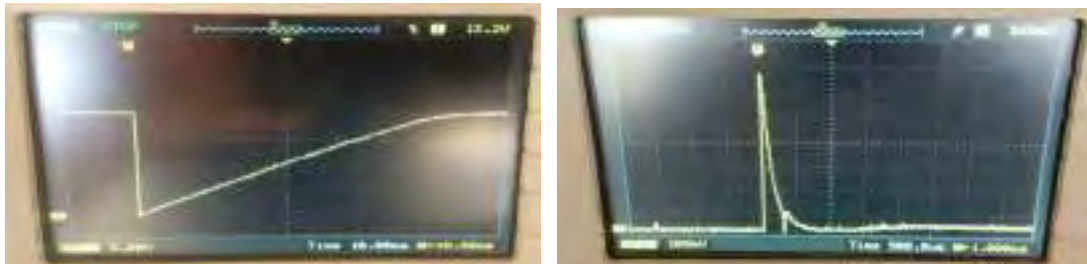
Figura 58: Tensión y corriente en el proceso de carga del capacitor (Elaboración propia).
