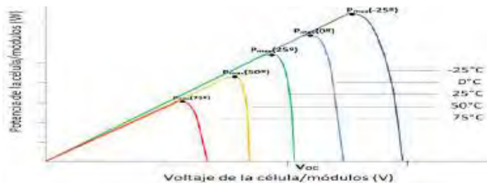
Figura 22: Variación de potencia máxima por efecto de la temperatura [16].
