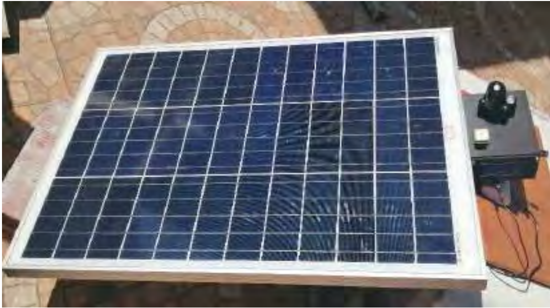
Figura 63: Sistema medidor de características eléctricas del Panel fotovoltaico (Elaboración propia).
