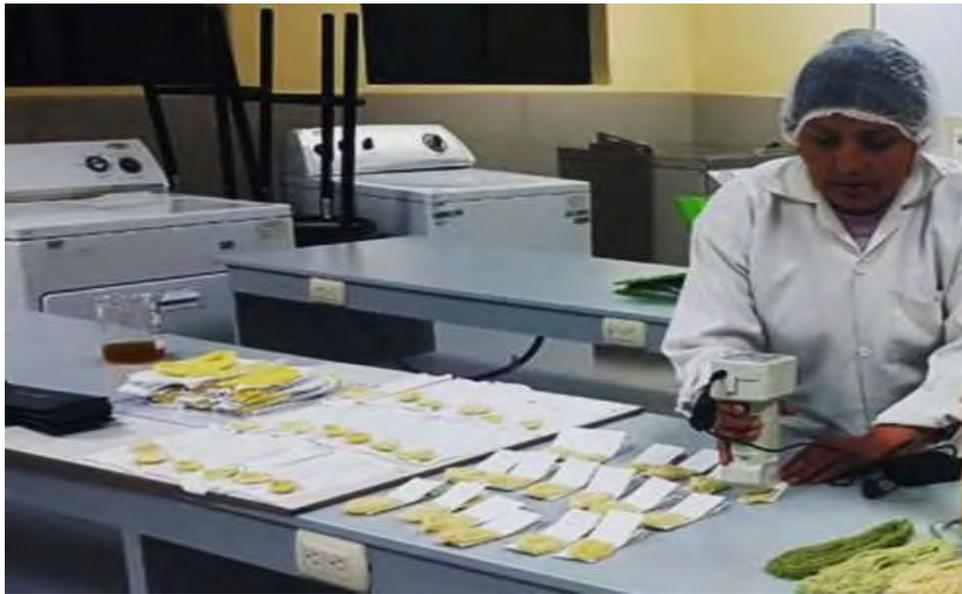
Realizando la evaluación de solidez a la luz con el equipo Espectrofotómetro.
