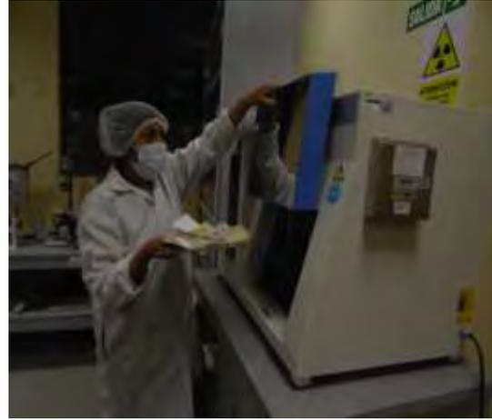
Retirando la muestra de cámara Xenoster
