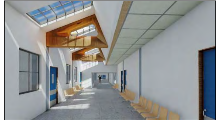
Figura 87 - Incidencia solar en el bloque de Consulta externa y su tratamiento formal para captar mayor luz solar.
