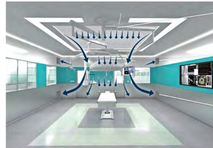
Figura 47. Sistema de renovación de aire en una sala de operaciones
