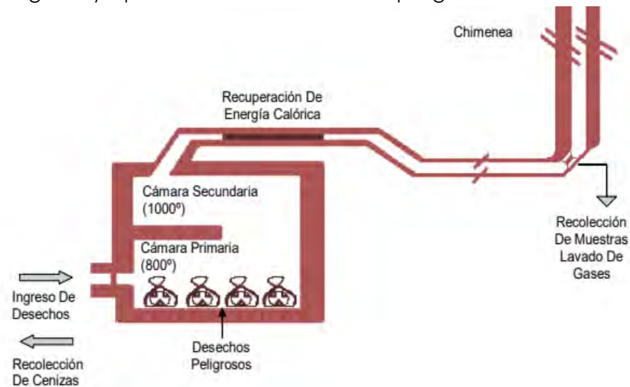
Figura 13 - Estructura básica de horno incinerador
