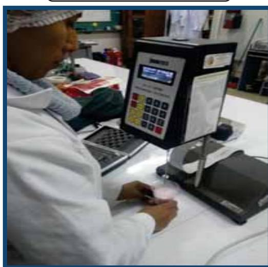
En la fotografía N° 15 se observa el viscosímetro utilizado para la determinación de la viscosidad en los shampoo.
