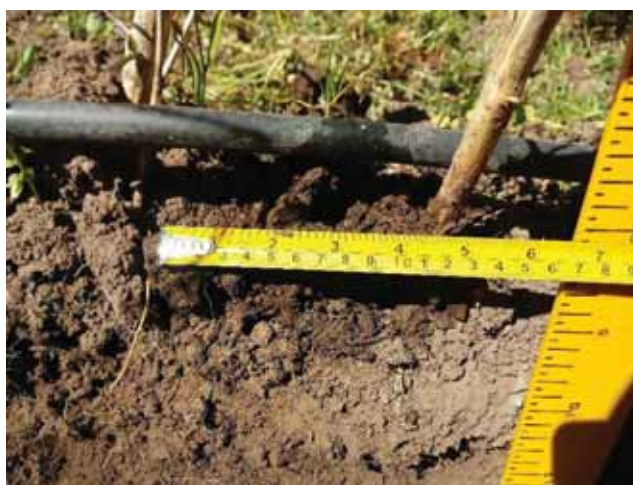
Foto 27. Diámetro de alcance del bulbo húmedo a los 15 minutos
