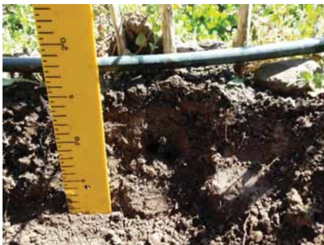
Foto 26. Profundidad de alcance del bulbo húmedo a los 15 minutos
