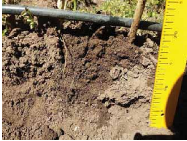
Foto 28. Profundidad de alcance del bulbo húmedo a los 30 minutos
