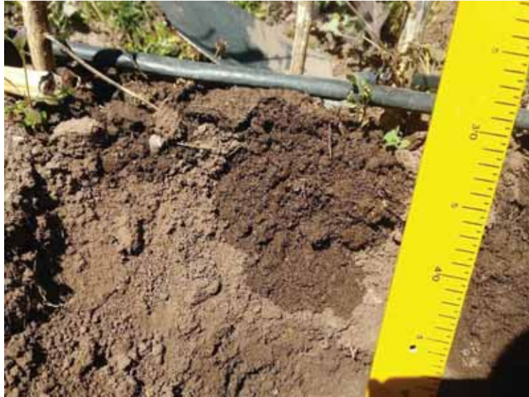
Foto 30. Profundidad de alcance del bulbo húmedo a los 45 minutos
