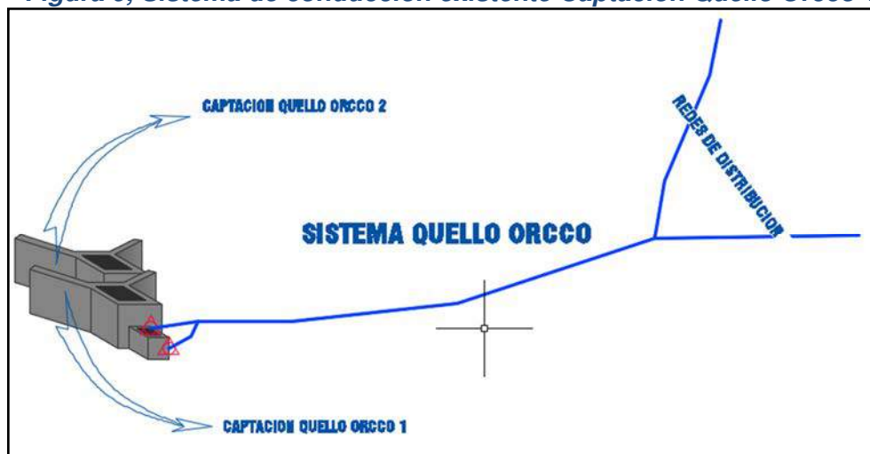
Figura 9, Sistema de conducción existente Captación Quello Orcco 1
