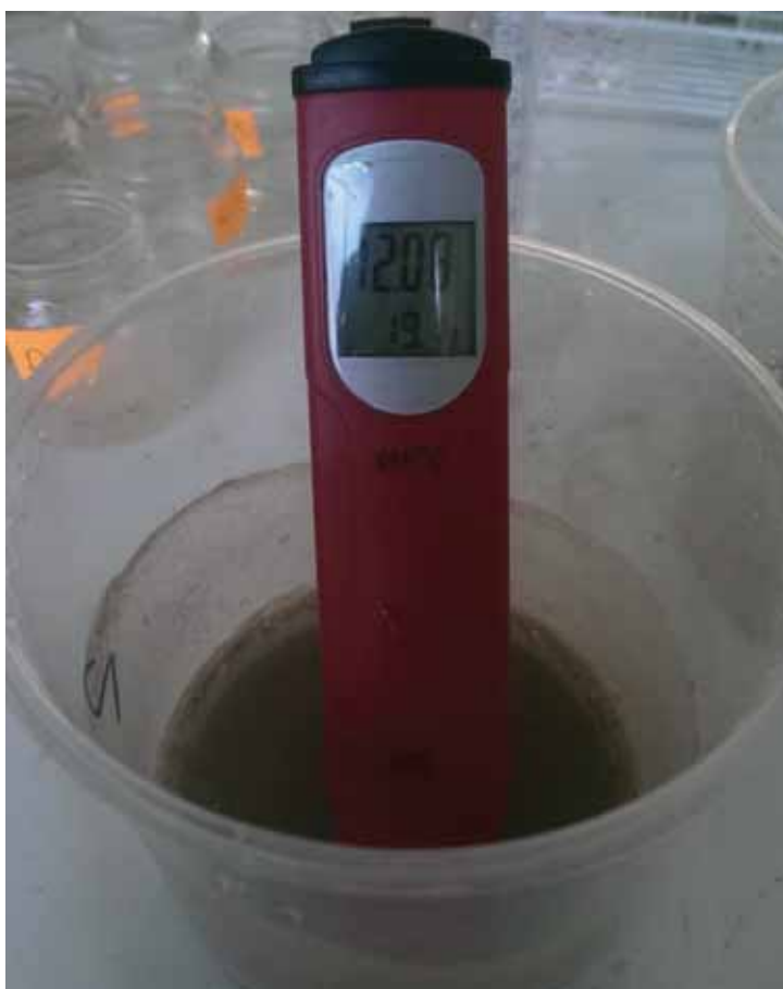
Foto 2. Medicion de pH de pulpa.
