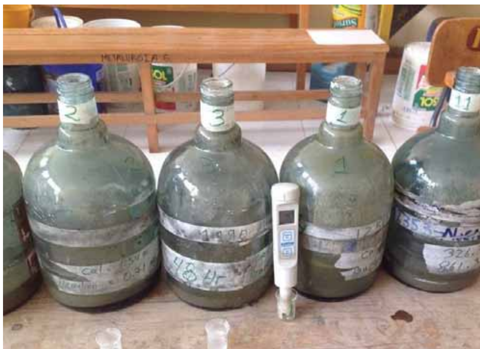
Foto 1. Pulpa en reactores de agitación
