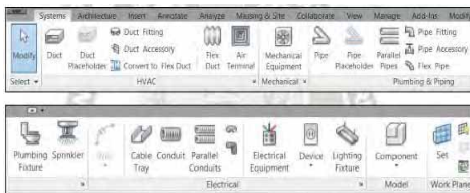
Figura 33. Cinta de herramienta de Revit MEP.
