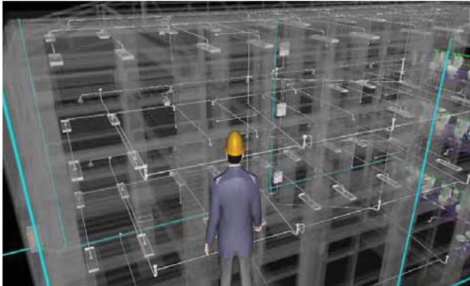
Figura 43. Vista de Instalaciones Electricas en Naviswork.
