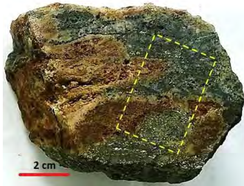
Fig. 8.1 Superficie de corte de muestra de mano mostrando el lugar exacto del que se preparó la sección delgada/pulida. Se observa la predominancia del cuarzo lechoso, que conforma bandas alternadas con sulfuros, principalmente pirita y arsenopirita (amarillo y blanco metálico). El cuarzo se observa gris cuando contiene fina diseminación de sulfuros. Se observa dedos de lixiviación, de derecha a izquierda, que generan porosidad y depositan hidróxidos de hierro pardos.
