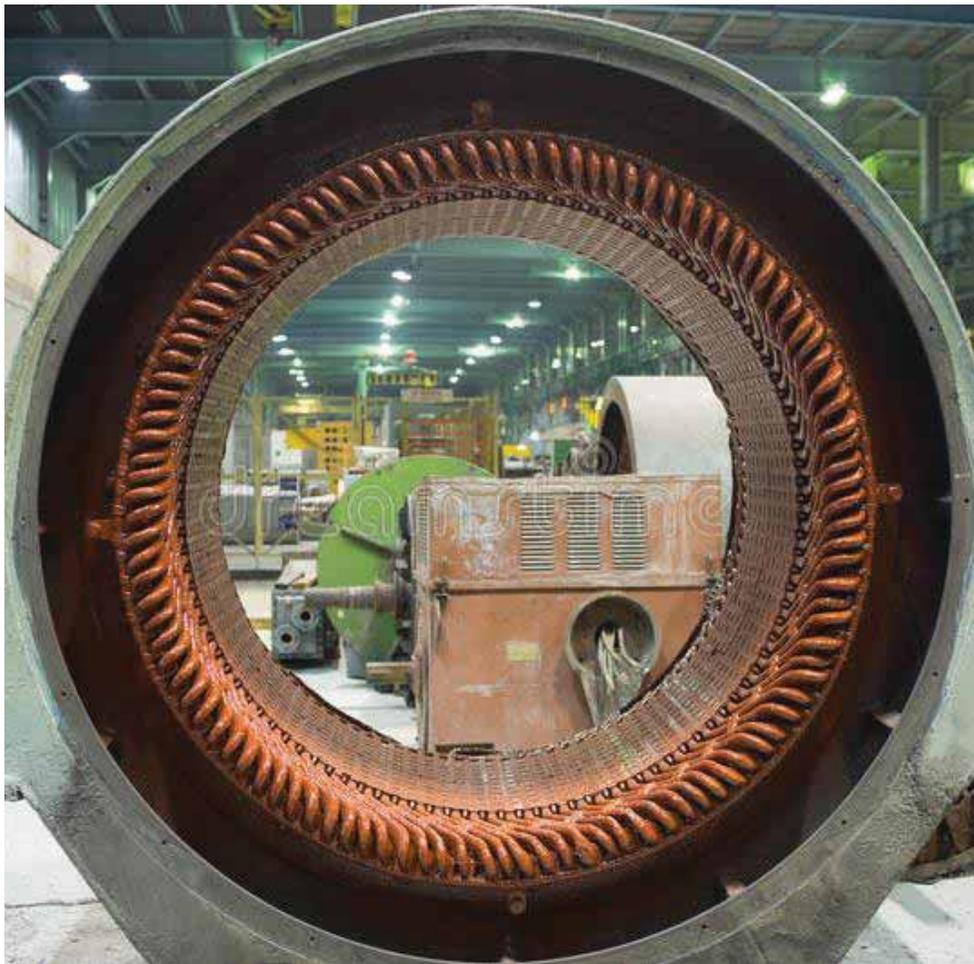
**Figura 2.8:** Estator y los devanados de armadura del generador síncrono
