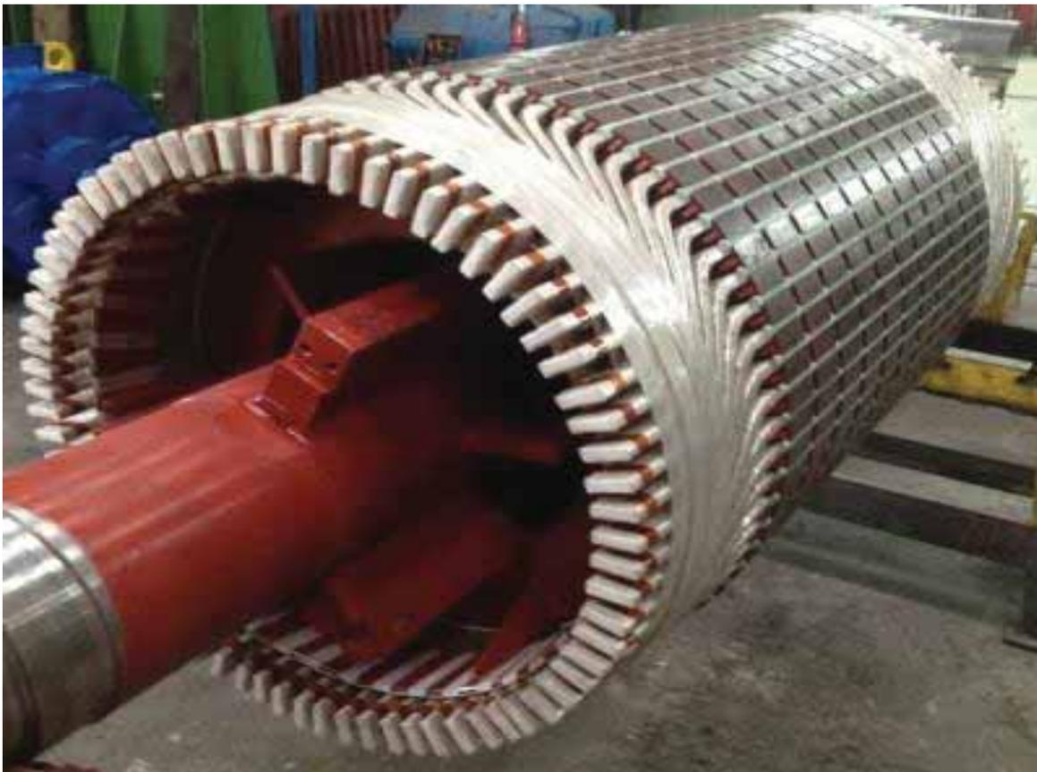
**Figura 2.4:** Rotor cilíndrico o sin saliencia.
