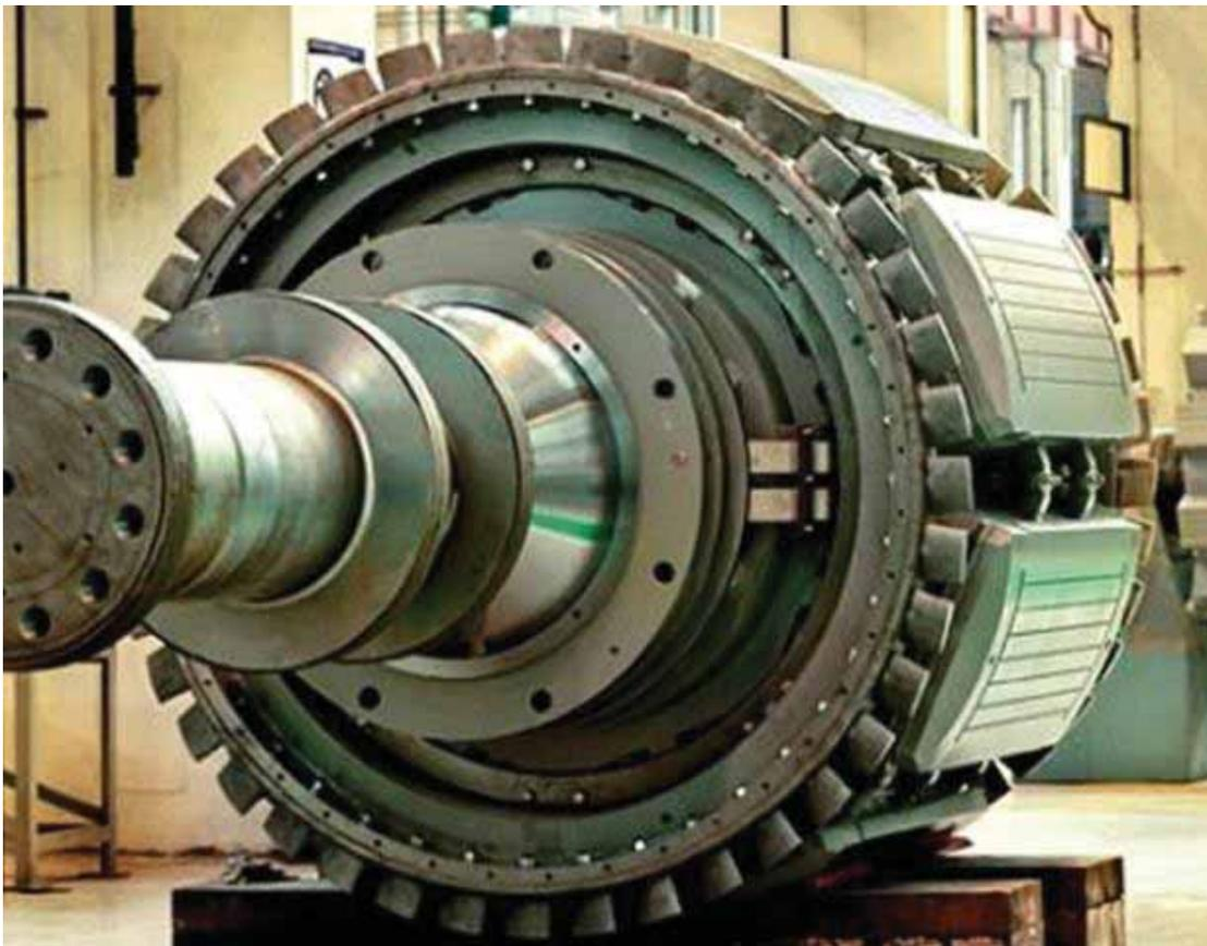
**Figura 2.6:** Rotor de polos salientes.
