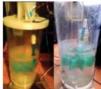
Figura 9: Armado de circuito electrónico, con adquisición de datos (a); Armado del reactor batch de burbujeo con sensores de pH y turbiedad (b).
