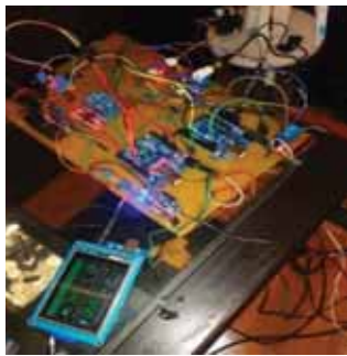
Figura 9: Armado de circuito electrónico, con adquisición de datos (a); Armado del reactor batch de burbujeo con sensores de pH y turbiedad (b).
