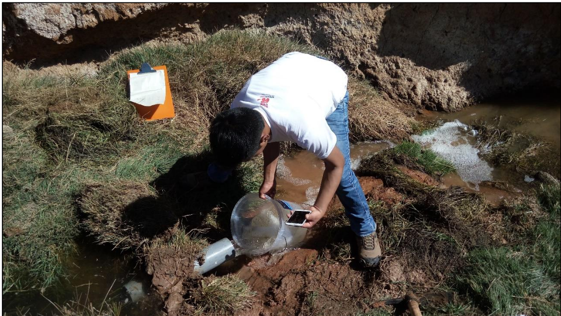
Fotografía N°6. Aforo del riachuelo de la microcuenca.
