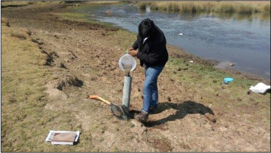
Fotografía N°19. Prueba de infiltración laguneta Uchuychaparccochoa 1.
