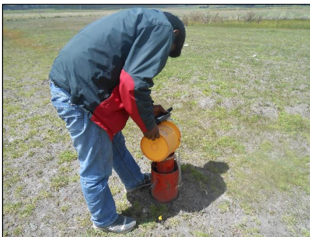
Fotografía N°16. Prueba de Infiltración con el anillo concéntrico.
