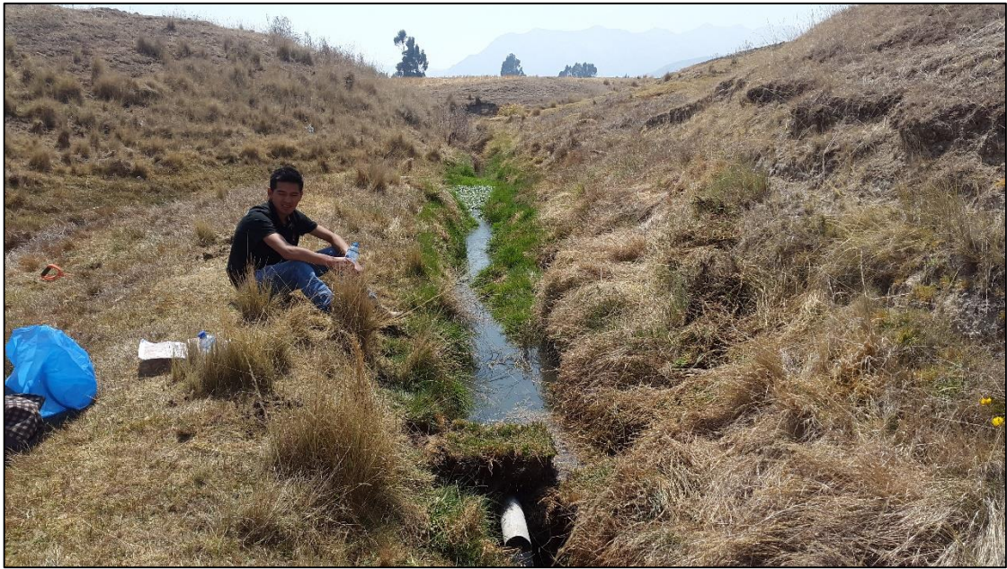
Fotografía N°5. Aforo del dren principal de la microcuenca.
