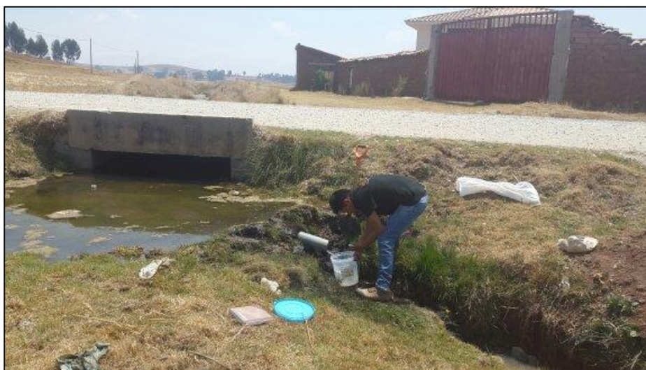
Fotografía N°11. Medida de caudal del cauce Izquierdo o dren Izquierdo.
