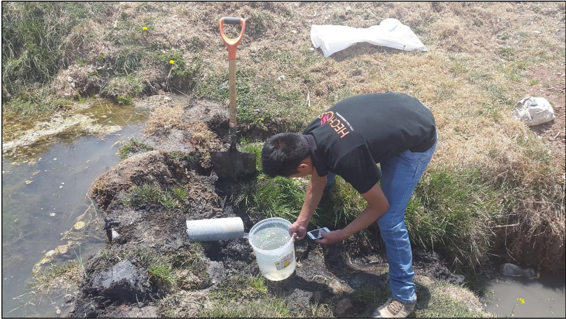
Fotografía N°7. Aforo del dren izquierdo de la microcuenca.
