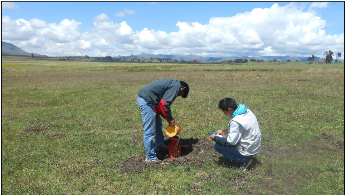
Fotografía N°18. Prueba de infiltración en mermepampa, sector Umanes.
