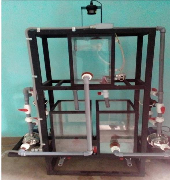
*Figura nro. 27 - Sistema de bombeo de agua a escala (vista posterior) - Fuente: propia.*
