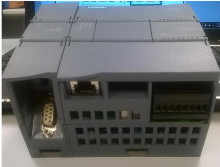
*Figura nro. 4 - PLC Siemens S7-1200 CPU 1212C – Fuente: propia.*
