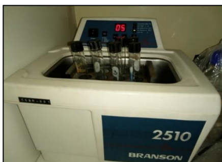
Fotografía 3. Someter las muestras al ultrasonido para dispersar la sustancia a analizar en la solución diluyente.
