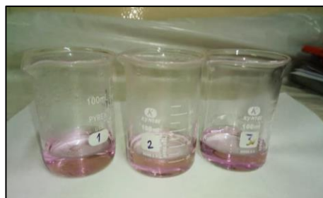
Fotografía 8. La solución permanece ligeramente rosada (indicativo de ausencia de sustancias oxidables).
