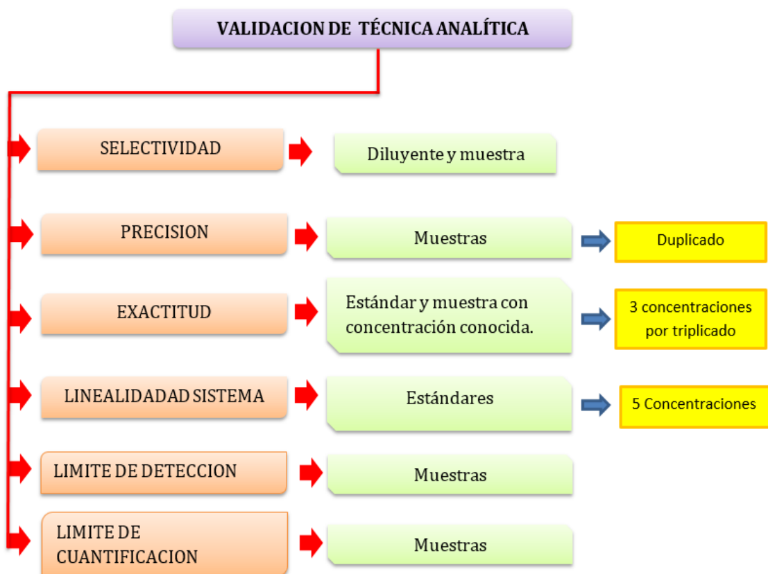
Figura N°11: Flujo del proceso de validación del método analítico para determinar trazas de principio activo (peor caso)
