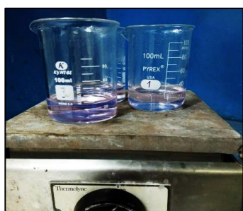
Fotografía 7. Llevar a ebullición por 5 minutos, si hay presencia de precipitado enfriar a baño de hielo hasta temperatura ambiente
