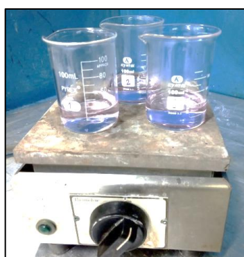
Fotografía 5. En 100mL de muestra de agua del ultimo enjuague, agregar 10 mL de H_2SO_4 2N y llevar a ebullición.
