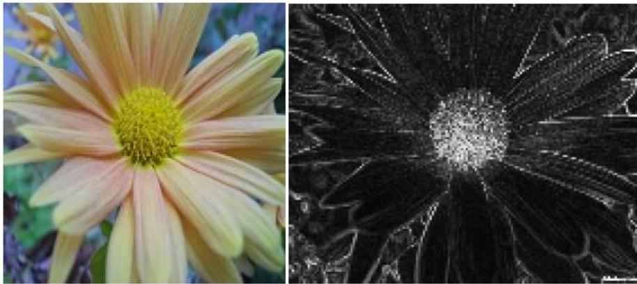
**Ilustración 5:** Reconocimiento de contornos mediante el operador Sobel.
