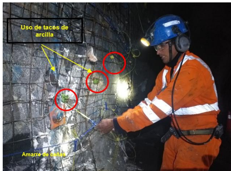
Ilustración 36. Uso de tacos de arcilla e el carguio
