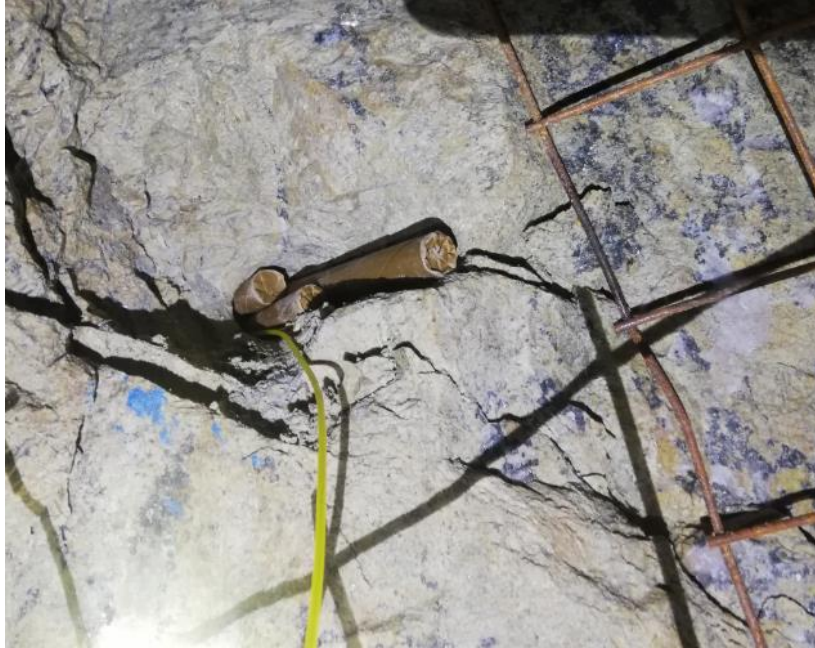
Ilustración 43. Colmatado de dinamita en un solo taladro por tenas del diametro de perforacion
