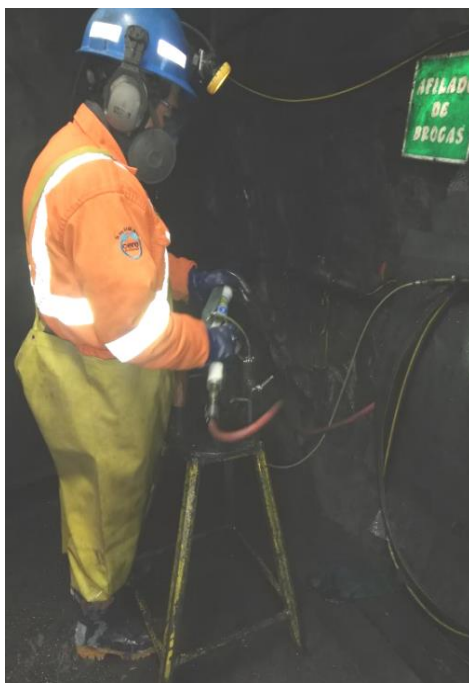
Ilustración 2. Proceso de afilado de brocas de mineral manual en el NV 150 U.M. Raura
