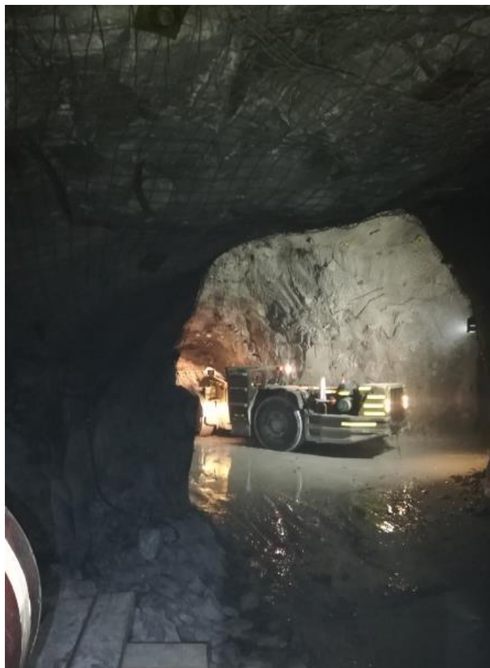
Ilustración 45. Limpieza de frentes con scoop
