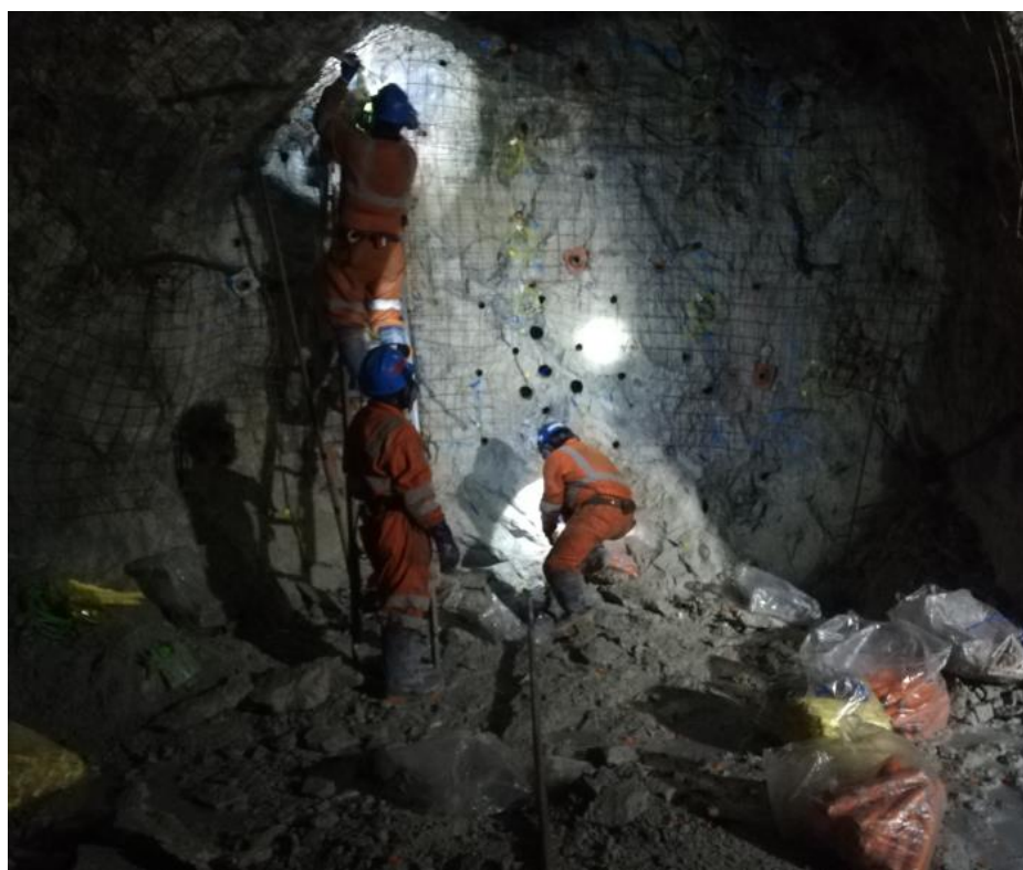
Ilustración 42. Carguio manual - Dinamita
