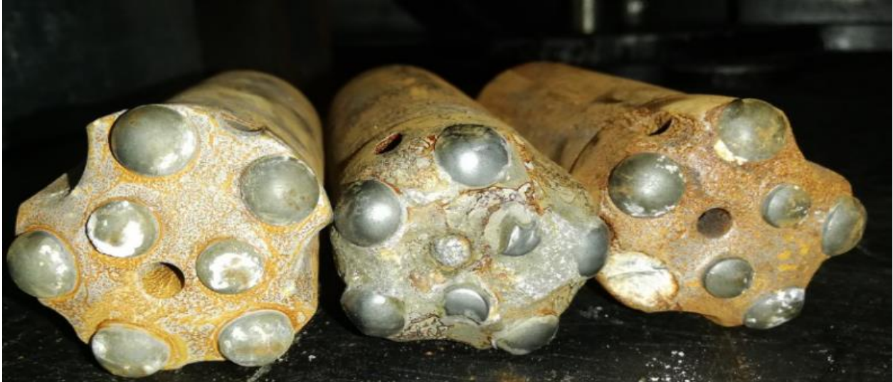
Ilustración 3. Brocas que ingresan al afilador de brocas en el NV 150 U.M. Raura
