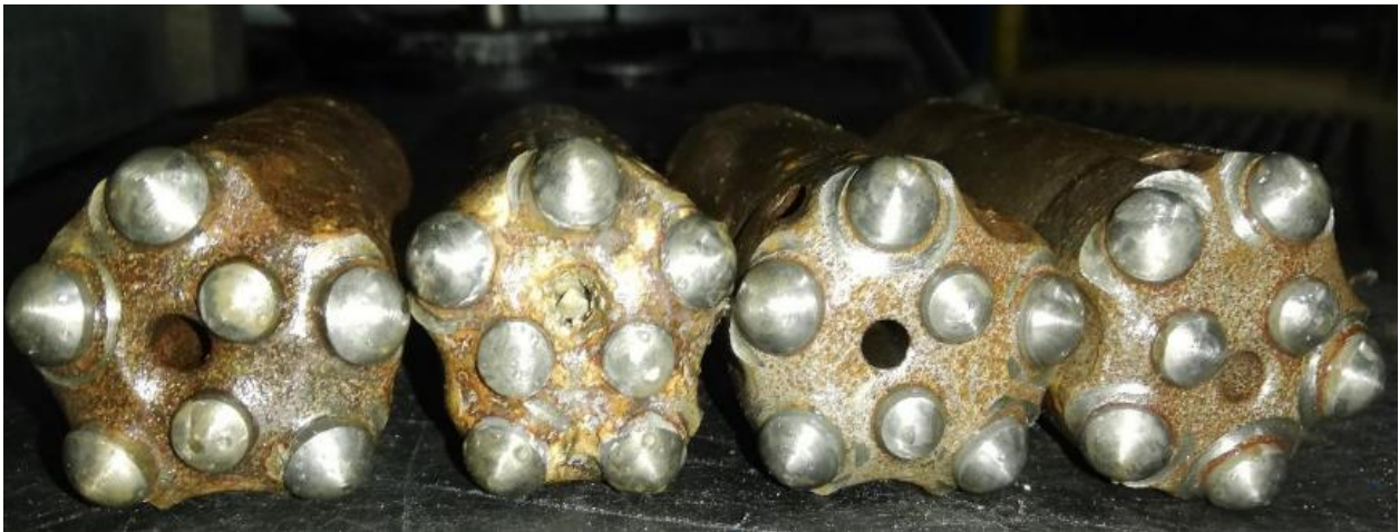
Ilustración 4. Brocas después de ser tratadas en el afilador de brocas en el NV 150 U.M. Raura
