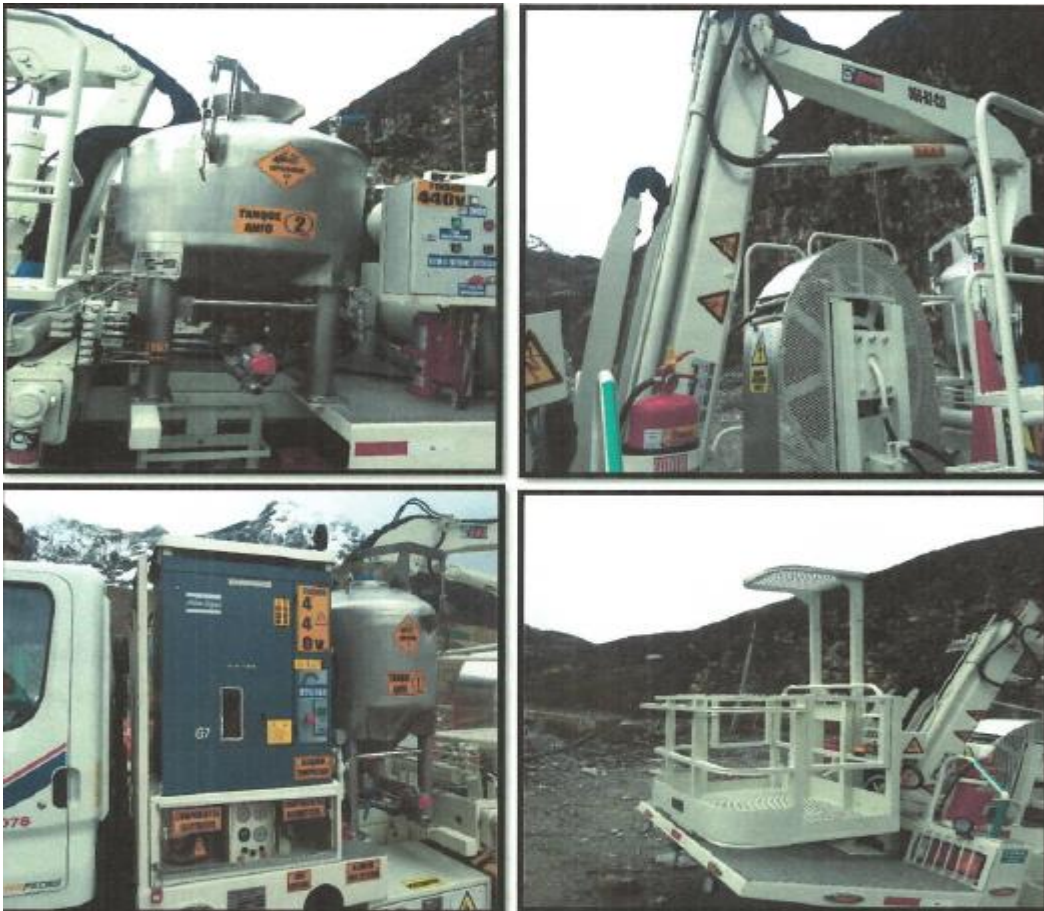
Ilustración 11. Características básicas del Anfoloader para el carguío con Anfo
