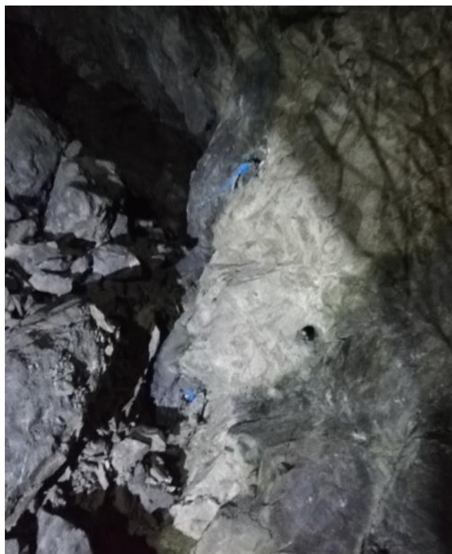
Ilustración 50. Tiros cortados y anillados por falta de simpatía existente en la emulsion en el XC 796-1
