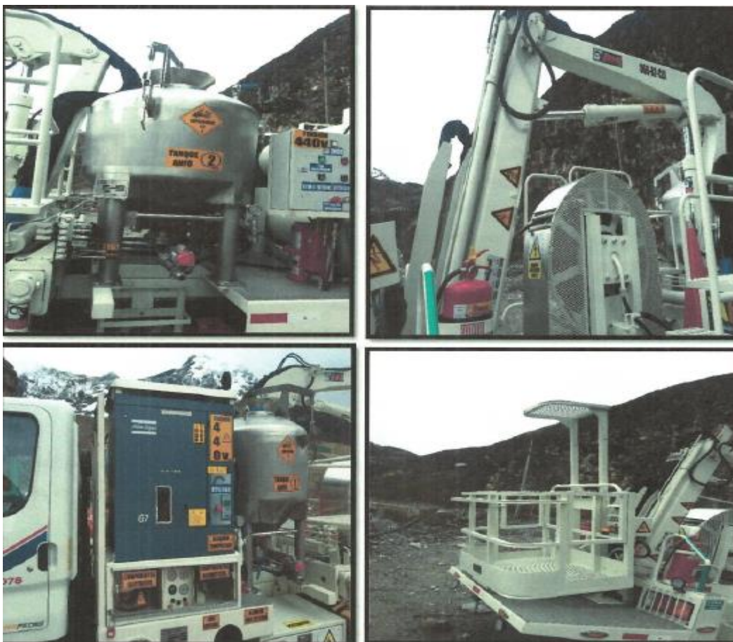
Ilustración 39. Características del anfoloader para el carguío mecanizado
