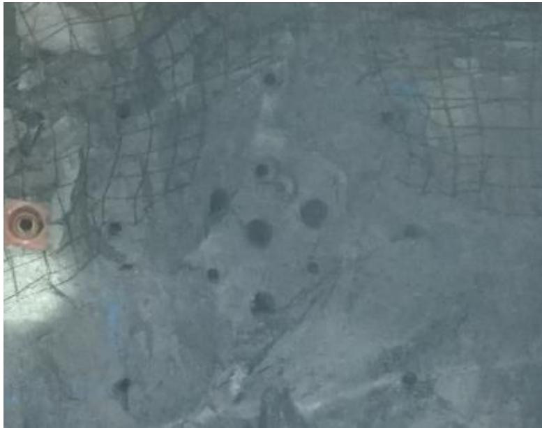
Ilustración 5. Corte Quemado realizado en el Crucero 796 U.M. Raura
