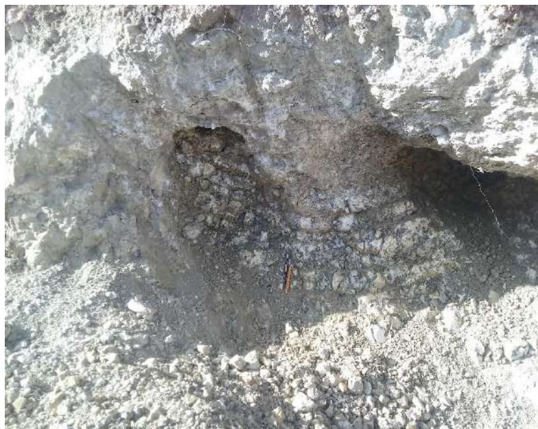
Fotografía 5.2 Niveles de calizas de poco espesor plegadas y fracturadas con humedad debajo de depósitos limo arcillosos
