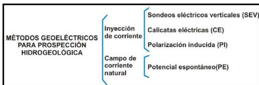
Ilustración 2.4 Métodos geoelectricos de prospección hidrogeológica. Fuente: (Auge, 2008)
