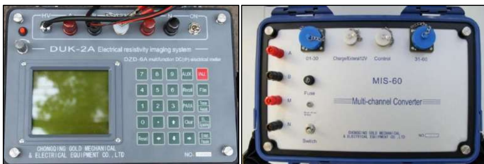
Ilustración 2.13 equipo DUK-2A y convertidor multicanal MIS-60. Fuente: Manual del equipo.
