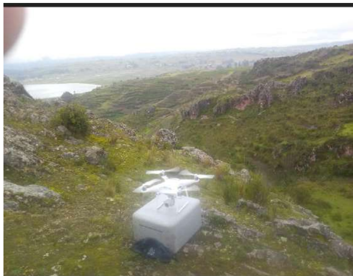
Ilustración 8.4 Levantamiento de imágenes aéreas con drone
