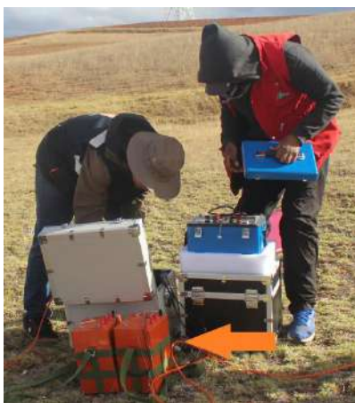
Fotografía 2.11 Conexión de la batería a resistivímetro.
