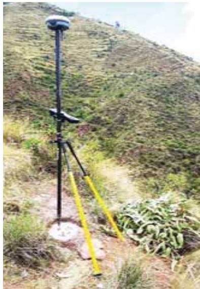
Intalacion de GPS Trimble GNSS R8S en el PC-01
