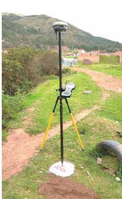
Instalacion de GPS Trimble GNSS R8S en el PC-05
