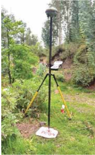
Instalacion de GPS Trimble GNSS R8S en el PC-04
