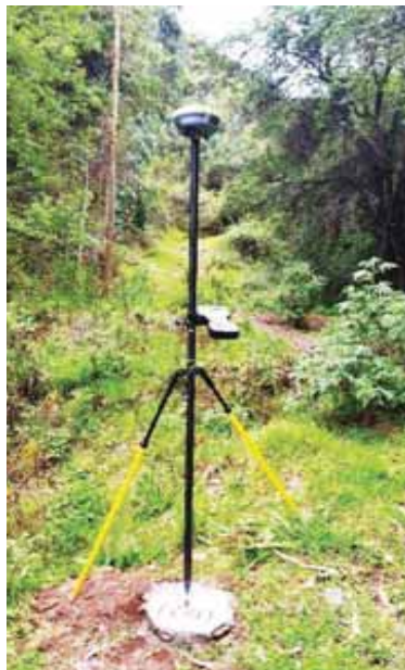
Intalacion de GPS Trimble GNSS R8S en el PC-03
