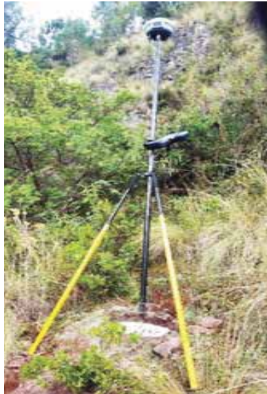
Intalacion de GPS Trimble GNSS R8S en el PC-02
