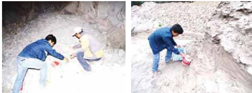
Fotografía 9: Recolección de muestras de agregado grueso y fino de la Cantera de Pisac
