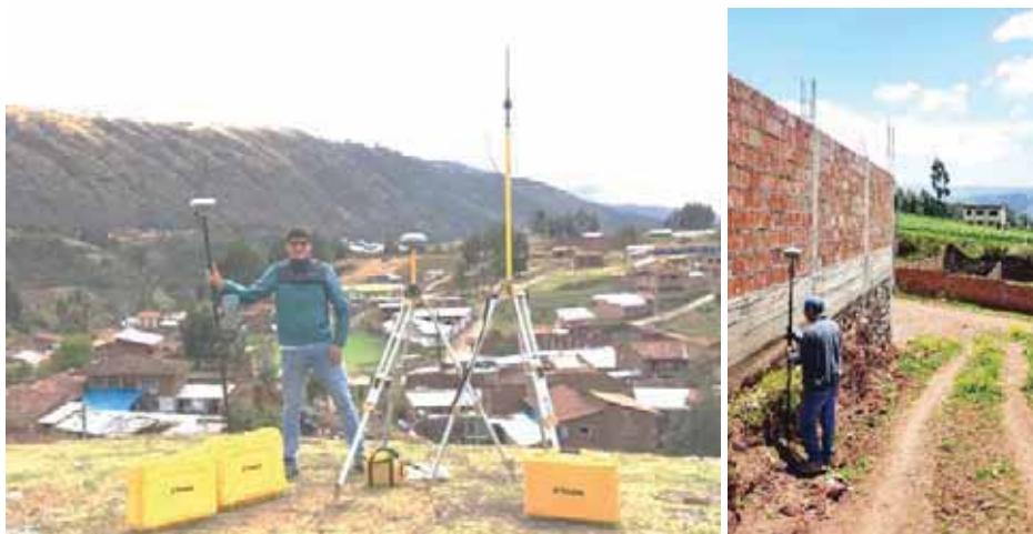
Fotografía 5: Equipo GPS diferencial Trimble R8S, Estilo de levantamiento RTK Radio
