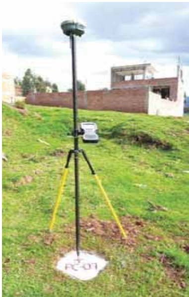
Intalacion de GPS Trimble GNSS R8S en el PC-07
