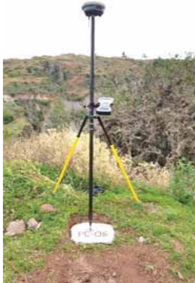
Intalacion de GPS Trimble GNSS R8S en el PC-06
