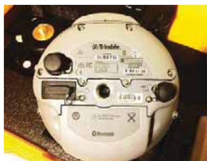
Vista posterior de Receptor GNSS.
