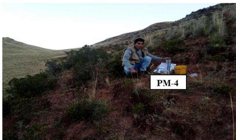
Foto 28. la Prueba de permeabilidad de la formación chilca. ubicado al SW de la cuenca Cachimayo.
