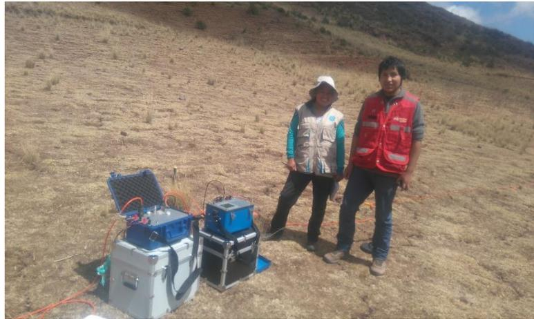
Foto 24. Se observa la instalación de los equipos. en la fotografía derecha se muestra la instalación de los 60 electrodos de combinación, la fotografía de la izquierda se ve todo el equipo de prospección geoeléctrica.
