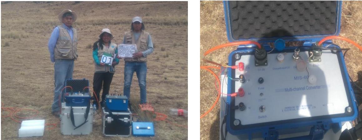
Foto 23. Observa A la izquierda Equipo Para Tomografía Geoeléctrica de 60 Multicanales, a la derecha se observa ambos equipos DZD-6A y DUK-2A con la batería de 12V- 45V-90V derecha se observa ambos equipos DZD-6A y DUK-2A con la batería de 12V- 45V-90V.
