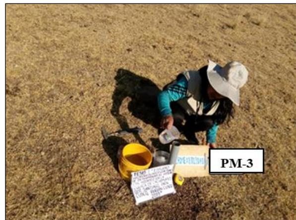
Foto 27. Prueba de permeabilidad en la formación Quillque.
