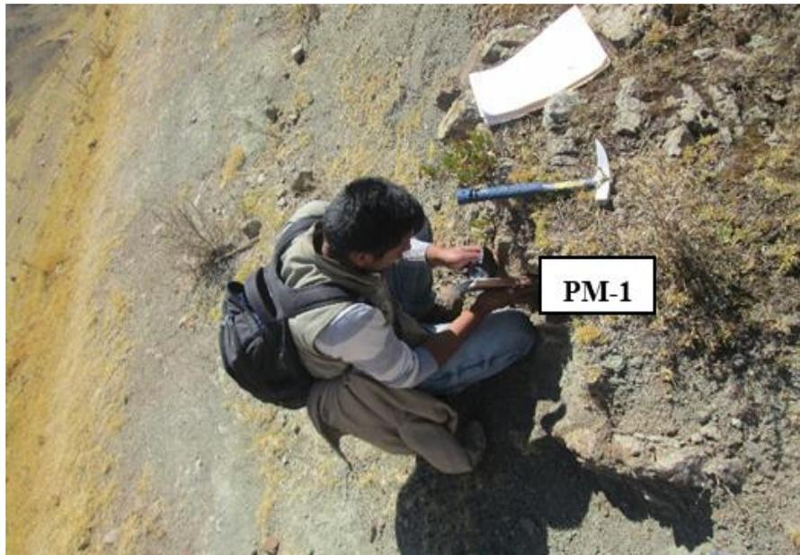
*Foto 26. Foto de la realización de la prueba de permeabilidad en la formación Puquín*
