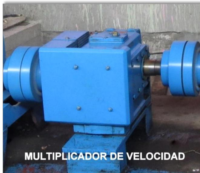
Foto N° 4.13: Multiplicador de velocidad y acoples elásticos.
