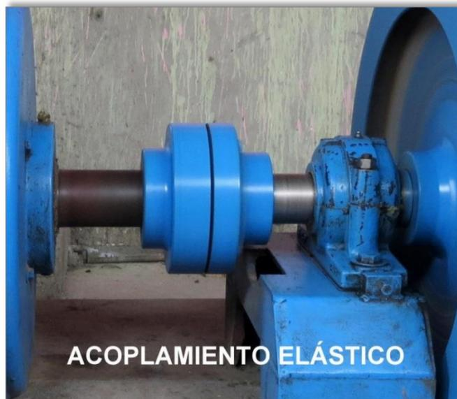
Foto N° 4.15: Acoplamiento elástico montado en el eje de rotación.
