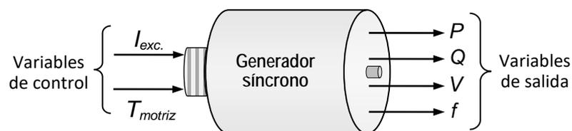
Figura N° 2.7: Variables de control y de salida en el generador síncrono.
