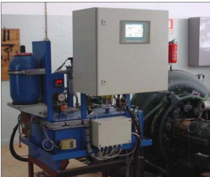
*Regulador instalado en el grupo hidráulico de pilotaje de la turbina Francis 400 KW.*
