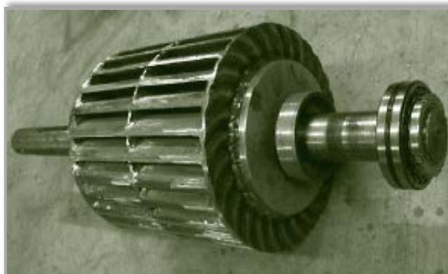
*Figura N° 2.2:* Rodete de eje horizontal de la turbina Michell - Banki.
