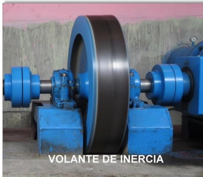
Foto N° 4.14: Disco volante de inercia entre los rodamientos.
