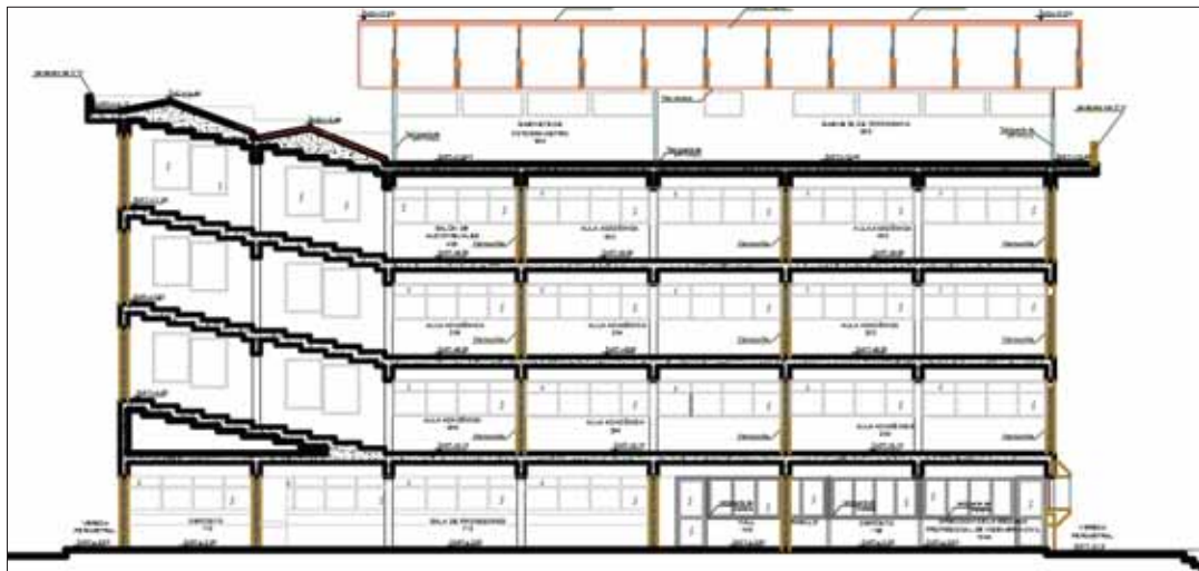
Figura 60. Corte Transversal Arquitectónico Edificación Antigua
