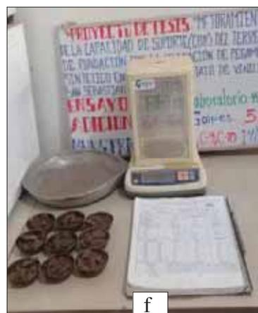
Las fotografías a, b, c, d, e y f muestra el ensayo de penetración y extracción de muestras para contenido de humedad para todo tipo de suelos.
