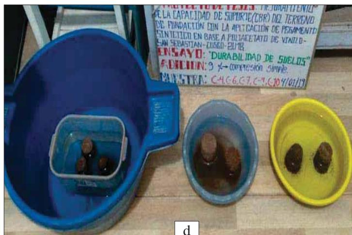
Las fotografías a, b, c y d muestran elaboración de especímenes para el ensayo de durabilidad, compresión simple y sumergido los primeros 20 minutos.
