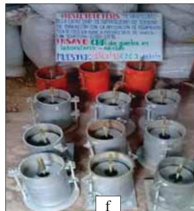
Las fotografías a, b, c, d, e y f muestra materiales, preparación, proceso de mezcla del aditivo y compactación de los moldes del ensayo CBR para todo tipo de suelos.
