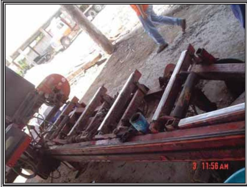
Figura 6 A. Aserradero portátil Wood-Maizer del aserradero 2
