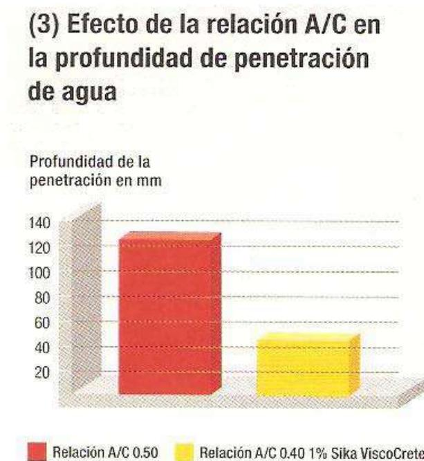
*Fuente: Concreto Proyectado Para Túneles Y Minas – SIKA*
