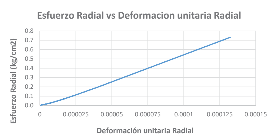
Figura 46: Esfuerzo Radial vs Deformación unitaria Radial - Cantera Huillque con Geotextil No Tejido Elaboración propia, 2018
