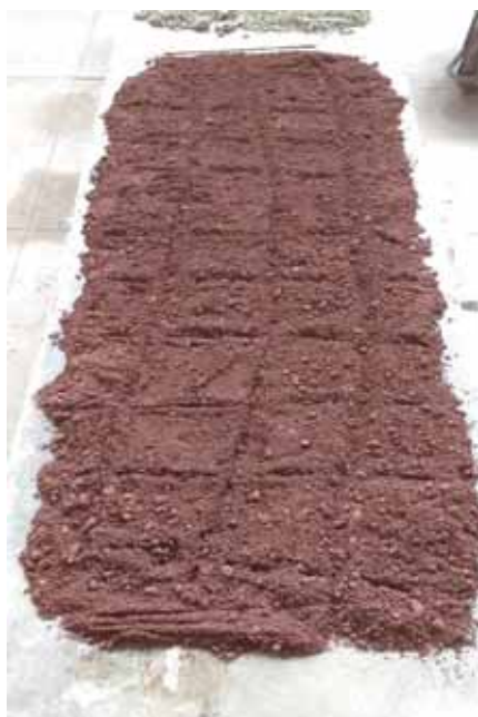
Fotografía N°06 y N°07: Secado de Muestra – Cantera de Vicho y Huillque
