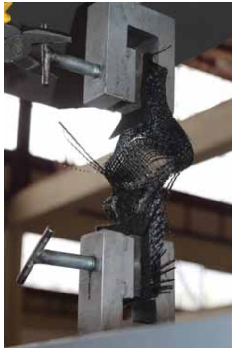
Fotografía N°26 y N°27: Ensayo de Carga de Rotura y Elongacion GRAB – Geotextil Tejido
