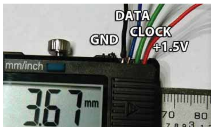
Ilustración 10: Conexiones realizadas sobre el calibrador para la captura de datos
