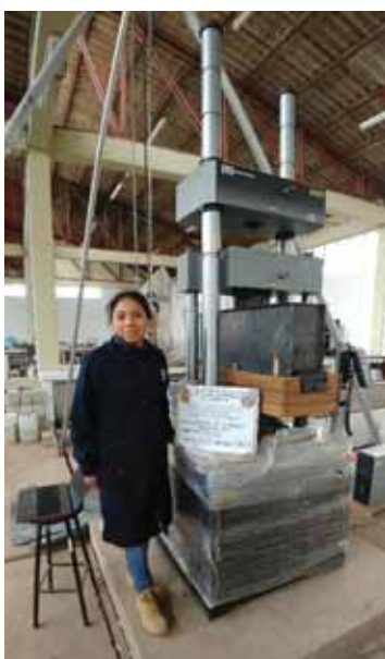
Fotografía N°38: Ensayo de Viga N°04 con geotextil Tejido
