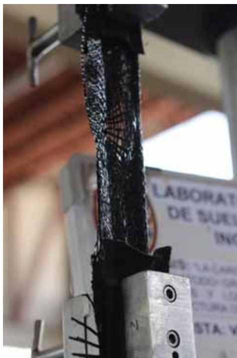
Fotografía N°28: Punto de Rotura – Geotextil Tejido T2400
