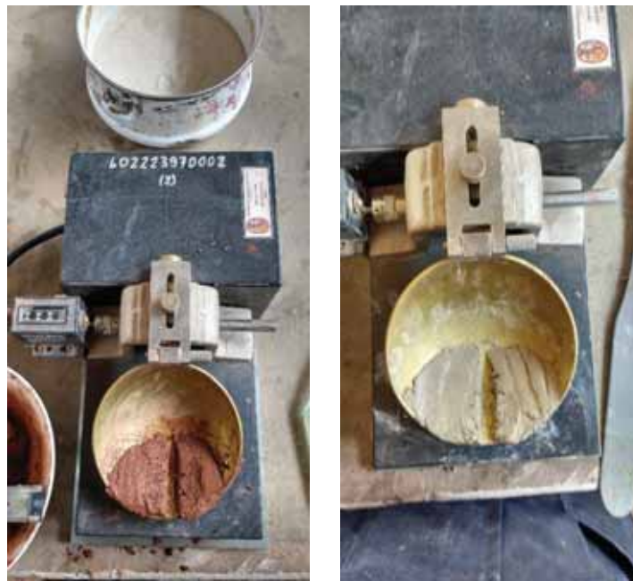
Fotografía N°11 y N°12: ensayos para el calculo de limites de consistencia
