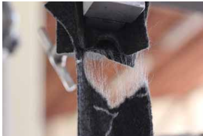
Fotografía N°23 y N°24: Ensayo de Carga de Rotura y Elongacion GRAB – Geotextil No Tejido
