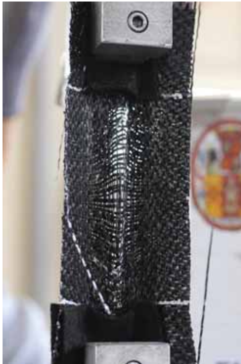
Fotografía N°26 y N°27: Ensayo de Carga de Rotura y Elongacion GRAB – Geotextil Tejido
