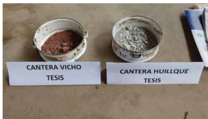
Fotografía N°09: muestra seca para ensayo de granulometria
