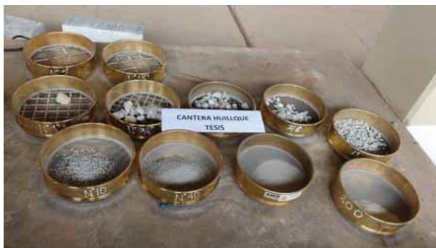
Fotografía N°15: Ensayo de Granulometria – Cantera Huillque
