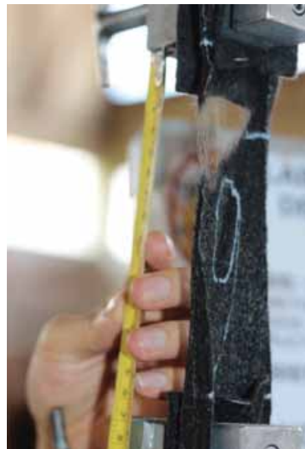
Fotografía N°23 y N°24: Ensayo de Carga de Rotura y Elongacion GRAB – Geotextil No Tejido
