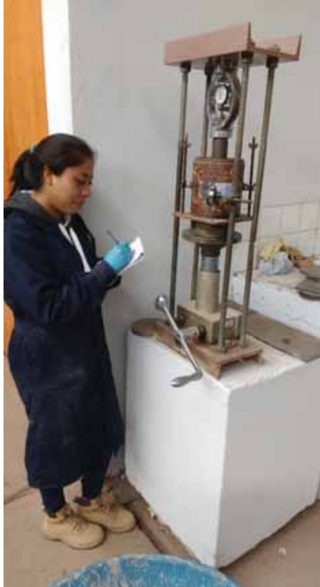
Fotografía N°18: Toma de datos – Ensayo CBR
