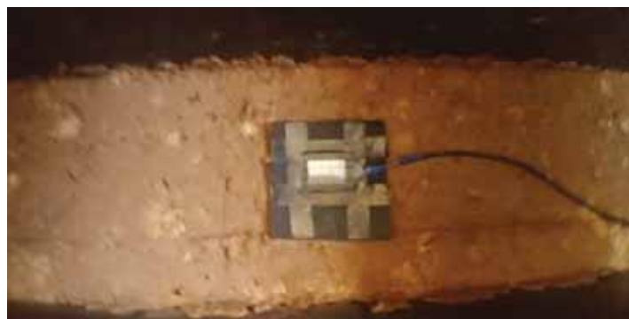
Fotografía N°32: Colocacion del strain gauge sin geotextil
