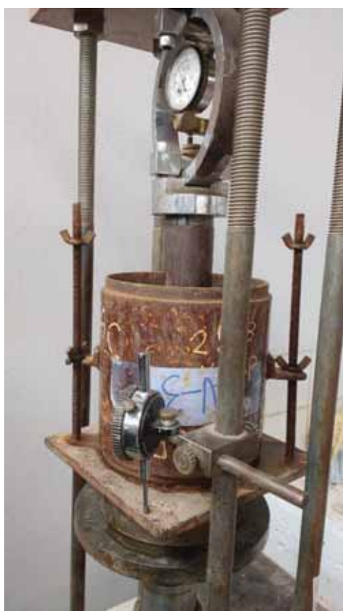
Fotografía N°16 y N°17: Ensayo de CBR – Cantera Vicho y Huillque
