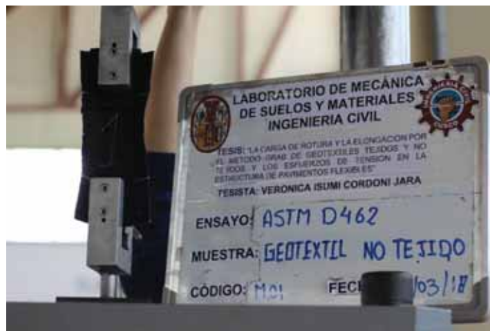
Fotografía N°22: Ensayo de Carga de Rotura y Elongacion GRAB
