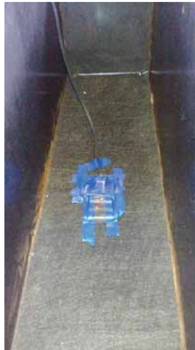
Fotografía N°30 y N°31: compactacion de los 5cm de subrasante en el encofrado metalico y colocacion del strain gauge sobre el geotextil no tejido
