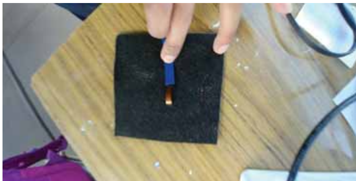
Fotografía N°33: colocacion del strain gaige sobre un retazo de geotextil no tejido para el ensayo
