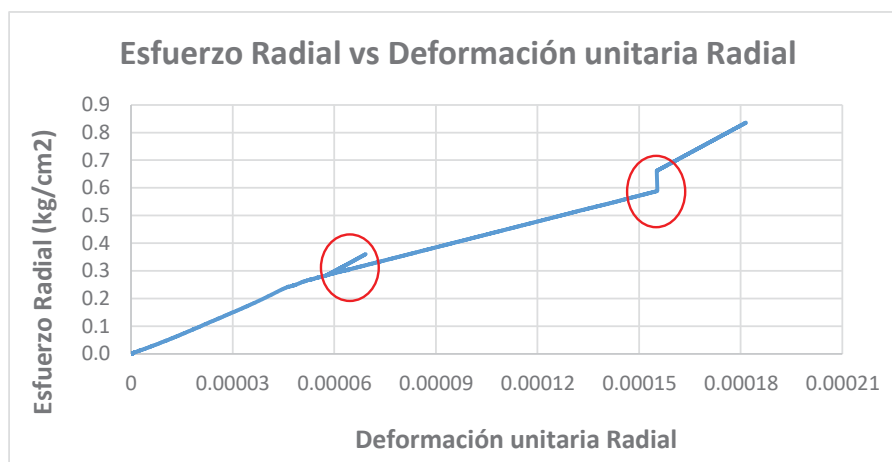
Figura 42: Esfuerzo Radial vs Deformación Radial – Cantera Huillque con Geotextil Tejido Elaboración propia, 2018
