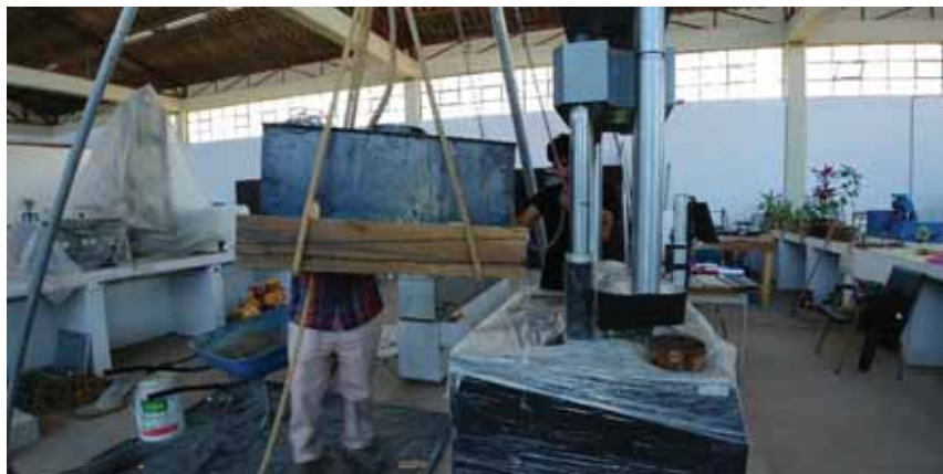
Fotografía N°36: colocacion de la viga en al Maquina universal para empezar con el ensayo
