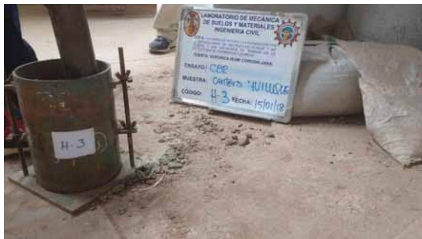
Fotografía N°13: Ensayo de CBR – Cantera Huillque
