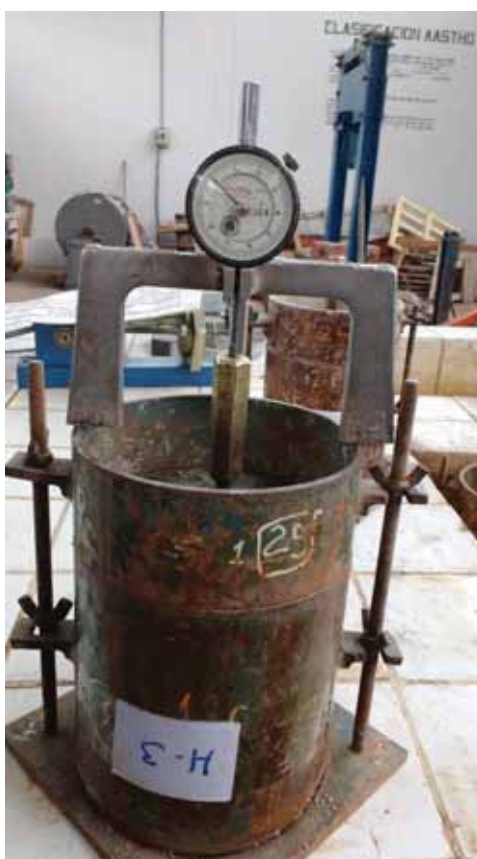
Fotografía N°16 y N°17: Ensayo de CBR – Cantera Vicho y Huillque
