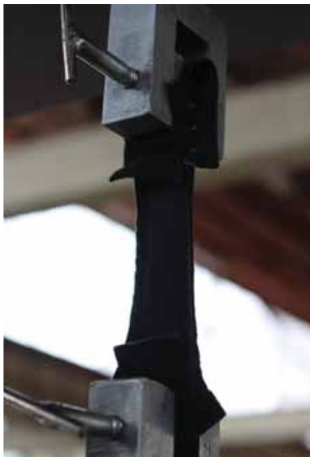
Fotografía N°23 y N°24: Ensayo de Carga de Rotura y Elongacion GRAB – Geotextil No Tejido
