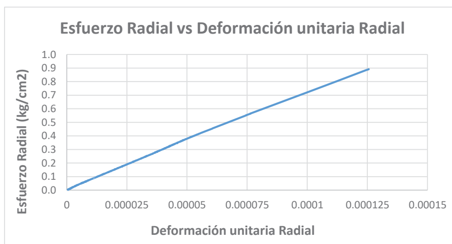
Figura 44: Esfuerzo Radial vs Deformación unitaria Radial - Cantera Vicho con Geotextil Tejido Elaboración propia, 2018
