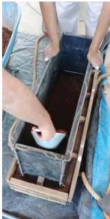
Fotografía N°30 y N°31: compactacion de los 5cm de subrasante en el encofrado metalico y colocacion del strain gauge sobre el geotextil no tejido
