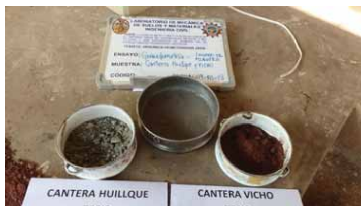
Fotografía N°08: lavado de muestra para ensayo de granulometria
