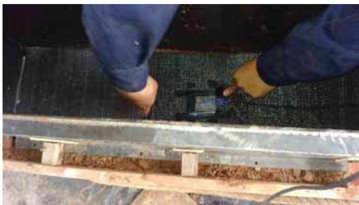
Fotografía N°34: colocacion del strain gaige sobre geotextil tejido T2400
