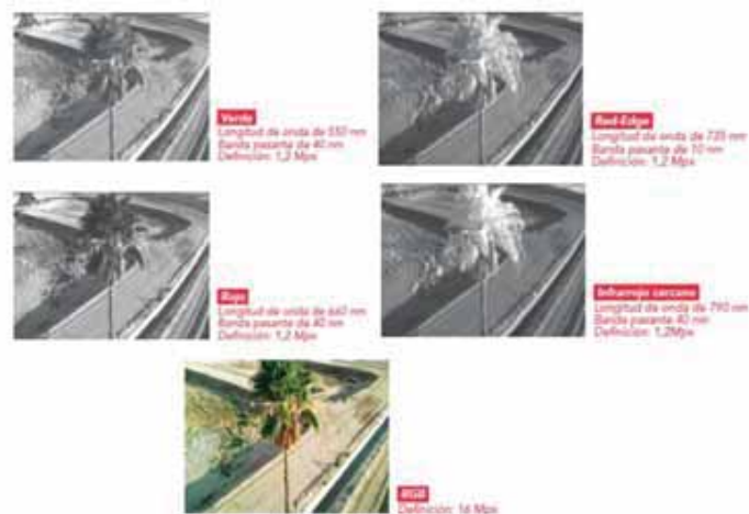
Figura 12: Bandas multispectral de captura del Parrot Sequoia
