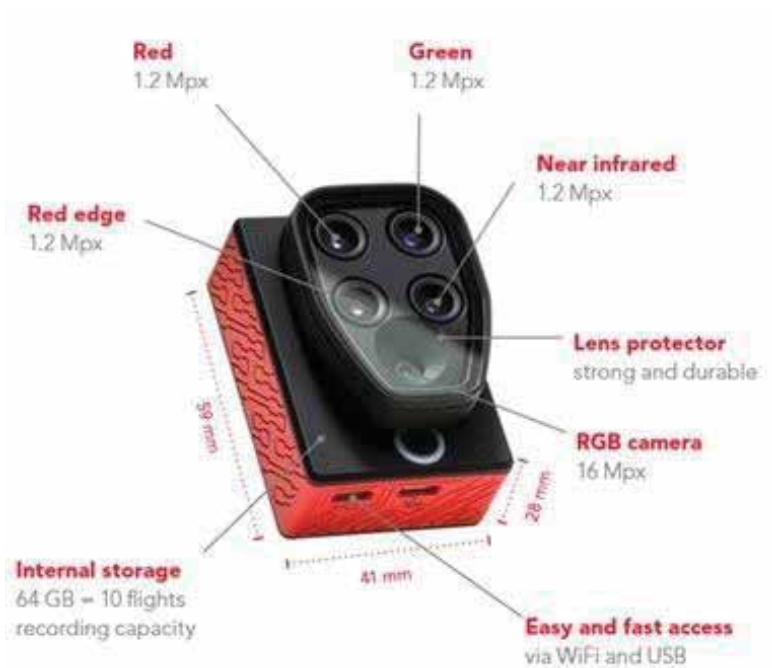
Figura 6: Cuerpo del sensor Parrot Sequoia.
