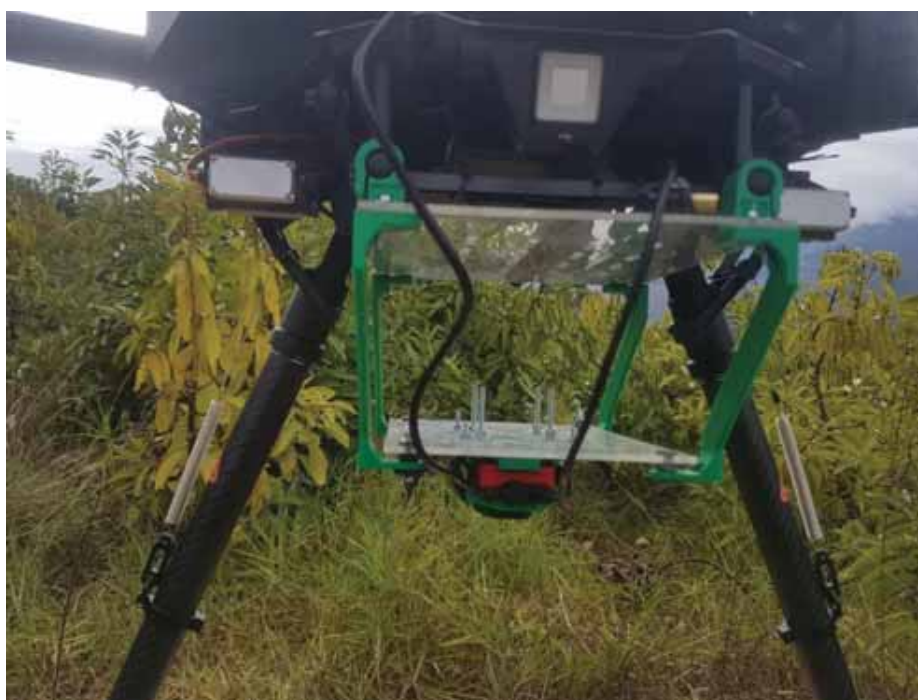
Gimbal montado sobre el UAV sosteniendo la cámara multiespectral. Fuente: elaboración propia.
