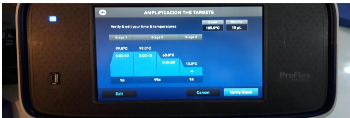
Figura 9: Programación del inicio de la fragmentación y amplificación del targets en el termociclador.
