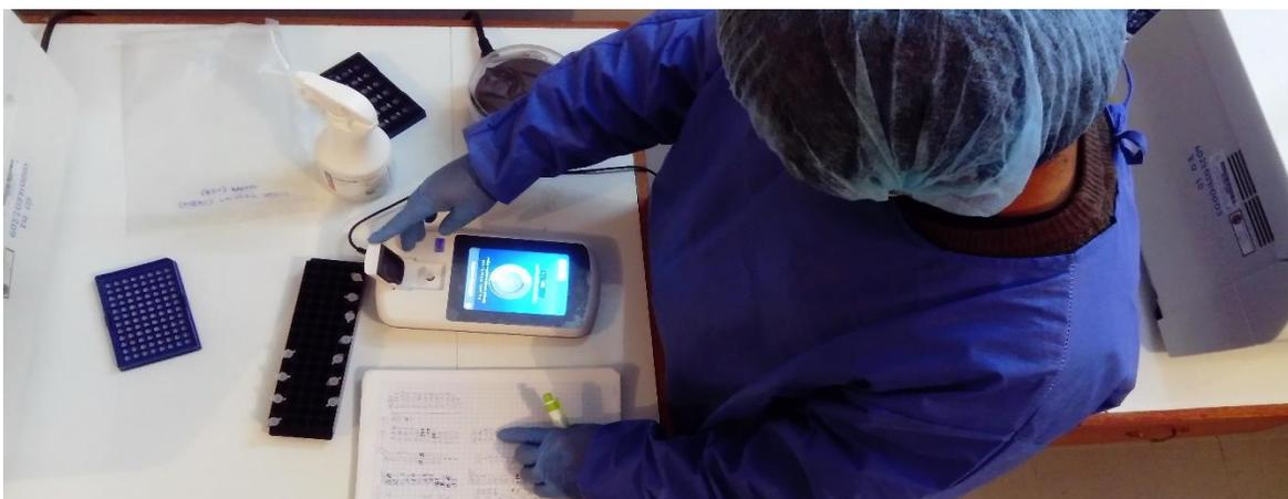
*Figura 8: Cuantificación de ADN purificado en el proceso de extracción con el instrumento Qubit™ Fluorometer.*
