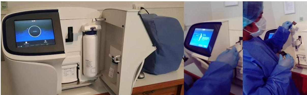
Figura 21: Equipamiento del equipo Ion S5TM Sequencer con los reactivos en descongelación y carga del chip 520 y centrifuga para rellenar las esperas en los pasillos.
