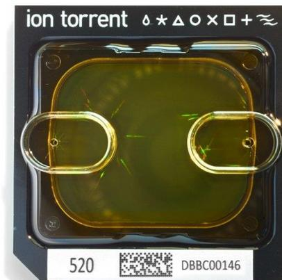
Figura 18: El chip Ion 520 detecta electrónicamente la incorporación de bases impulsadas por el ADN polimerasa y Sphere™ Particles, en la secuenciación al incorporarse cada perla en cada pocillo que presenta el chip.
