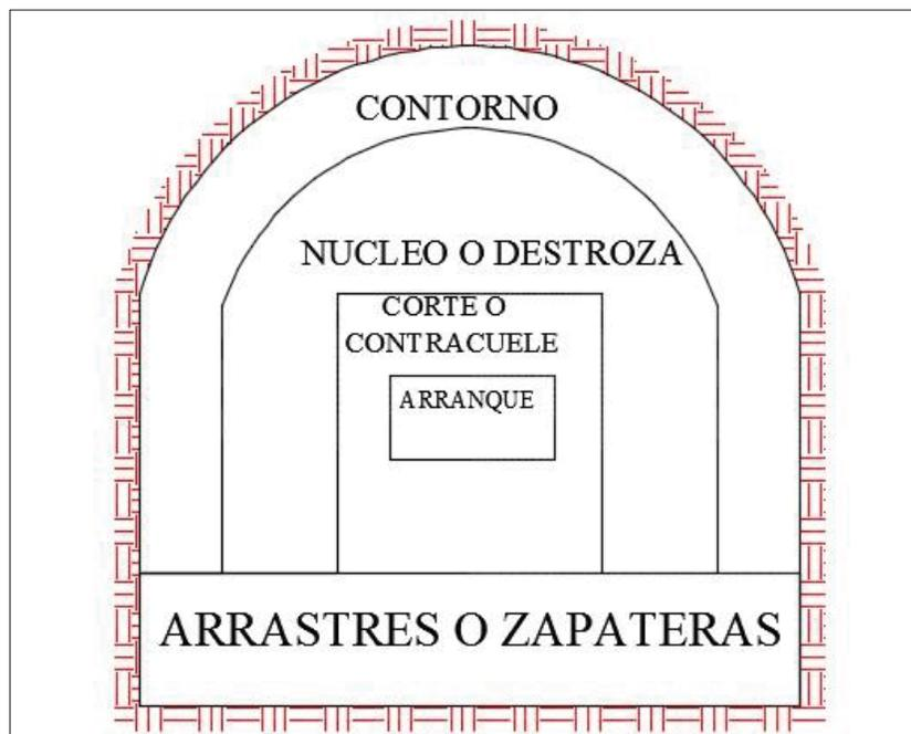
*Figura 4:* Secciones de perforación y voladura en un frente
